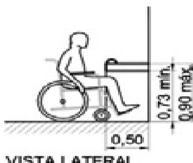
Figura 2 - Modelo de bebedouro de acordo com as normas da ABNT.
