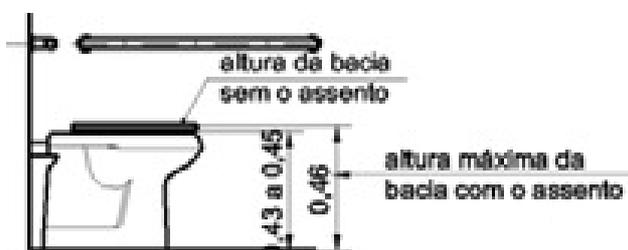
Figura 3 - Modelo de vaso sanitário de acordo com as normas da ABNT.
