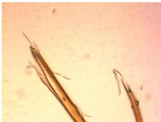
**Figura 10** - Ponta dupla rompida tratada com amostra “C” aumento 40 x 0.25.
