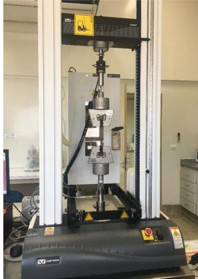
**Figura 2:** Fotografia ilustrativa do equipamento de ensaio de tração Instron.
