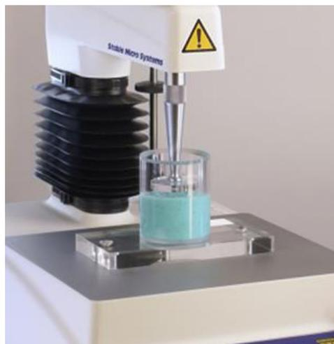
**Figura 1:**Texturômetro (TA.XT<sup>®</sup> Plus), Fonte: Adaptado de Extralab Brasil
