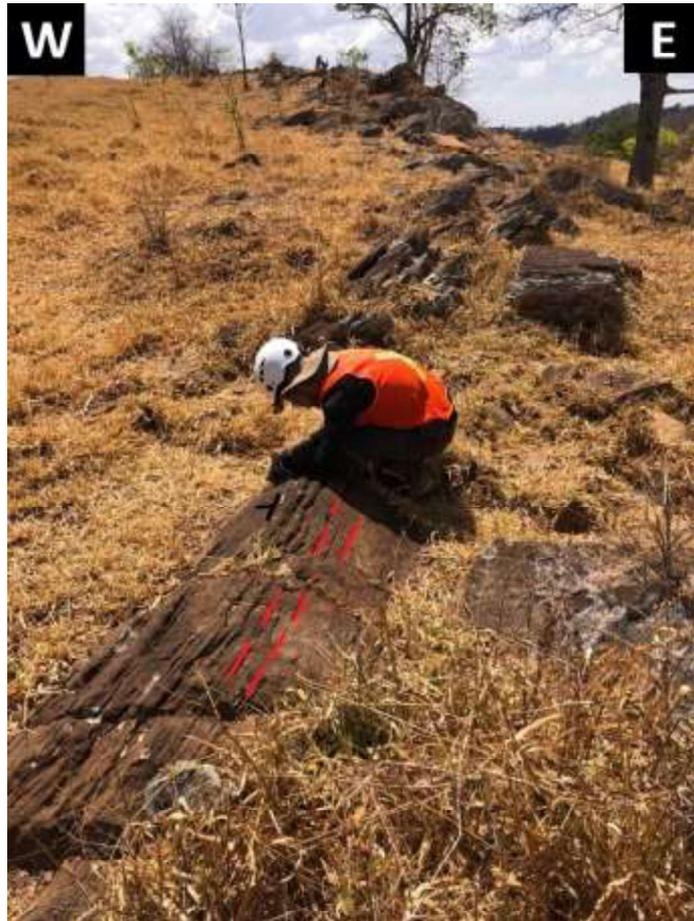
**Figura 28:** Foliação  $S_n$  observada em afloramento de quartzitos da unidade psamo-pelítica da SAI (ponto 20TF03\_127).
