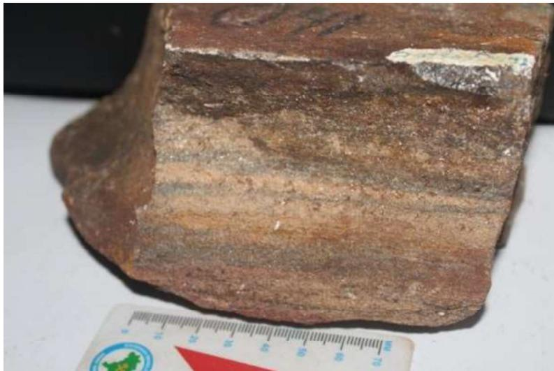
**Figura 16:** Amostra de magnetita quartizito (ponto 20TF03\_041).
