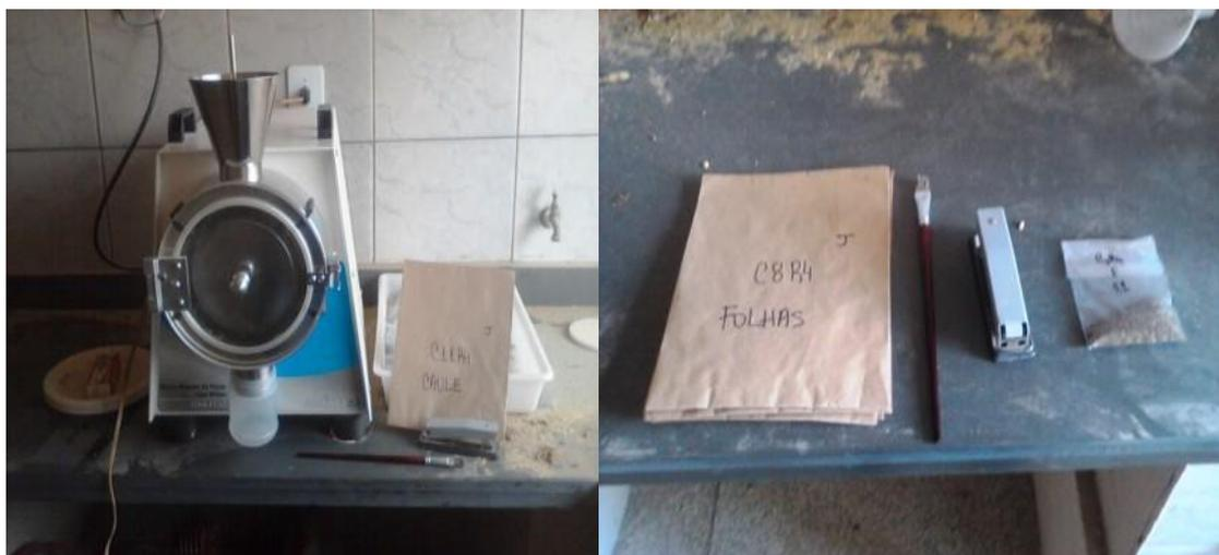
**Figura 5.** Amostras sendo trituradas em moinho de facas tipo Willey sendo passadas em peneira de 20 mesh. Urutaí-GO, 2011.
