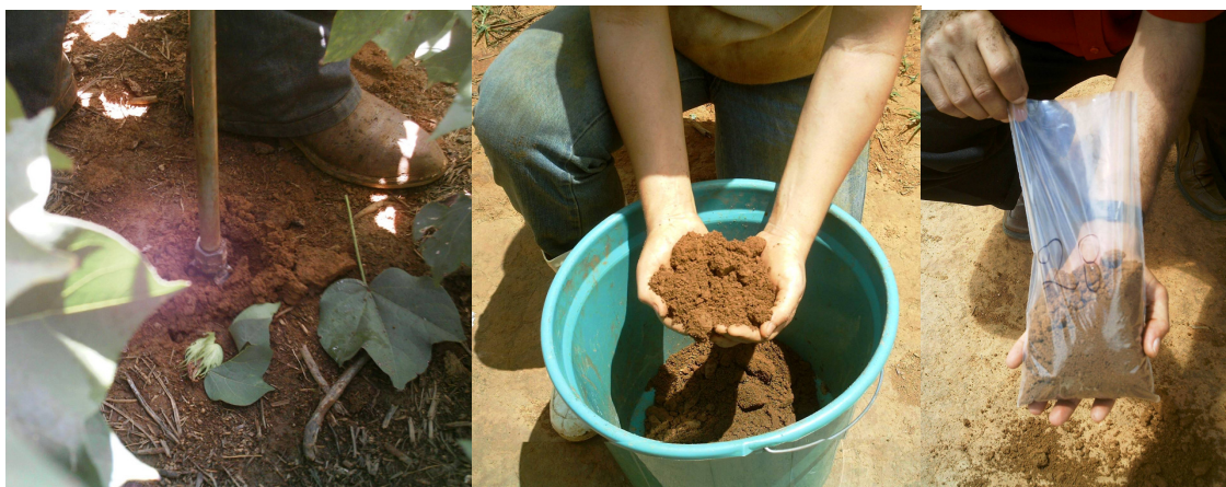
Figura 2. Procedimento da coleta de amostras de terra na área plantada com a cultura do algodão em área comercial no município de Silvânia, GO, safra de 2007/08.
