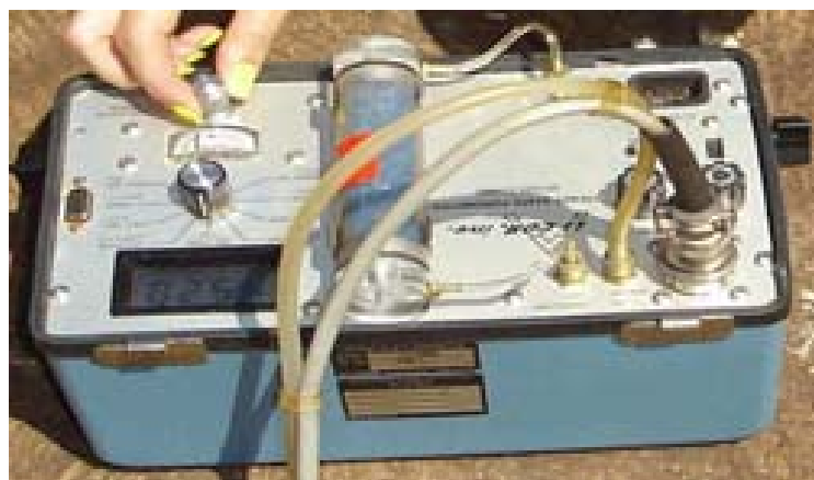
Figura 10. Equipamento usado na casa de vegetação, porômetro – LI-COR 1600 – para mensurar a transpiração e a condutância estomática foliar, nos dias 22/09, 01/10, 05/10, 13/10 e 21/10 de 2006.
