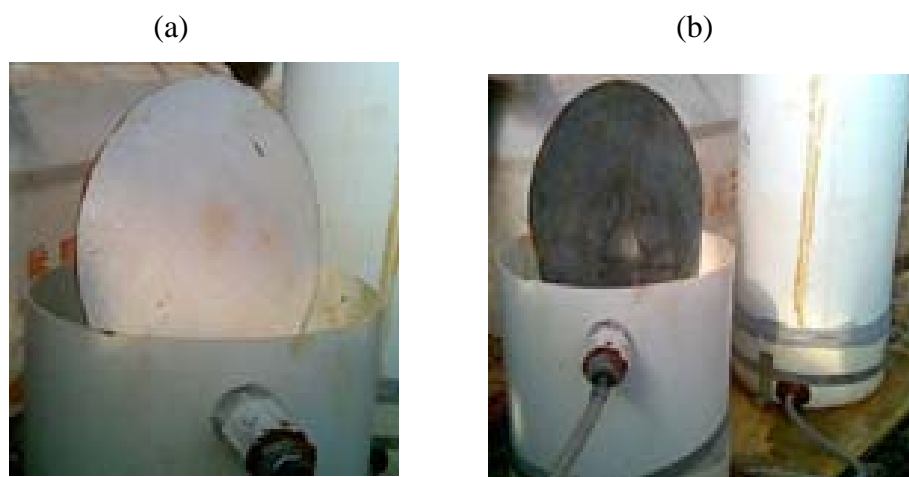
Figura 5. Detalhamento dos espigões de aço galvanizado, conexões e tampa do reservatório (R2) confeccionado de chapa de metálica, com a parte interna revestida de câmara de pneu e a parte externa com pintura esmalte branca.
