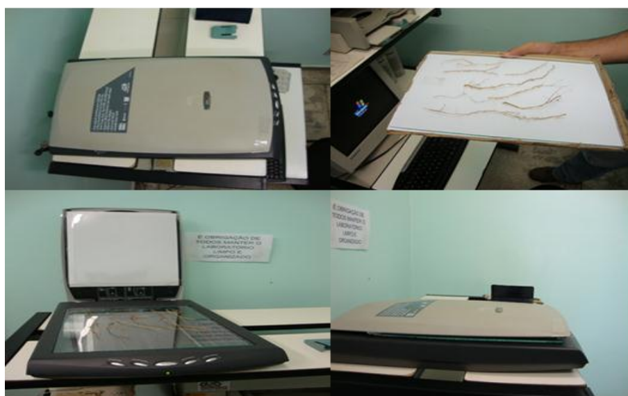
Figura 5.6. Procedimento de digitalização de raízes de milho com auxílio de escâner de mesa e microcomputador.
