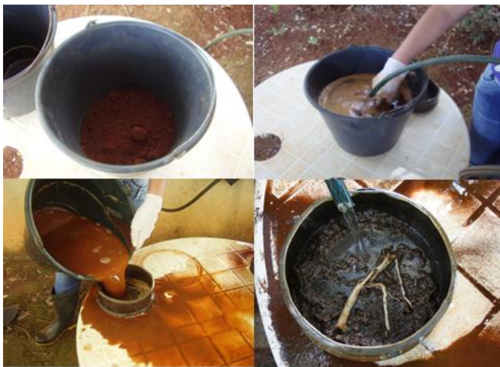
Figura 5.3. Separação do solo e raízes de milho com uso de água.
