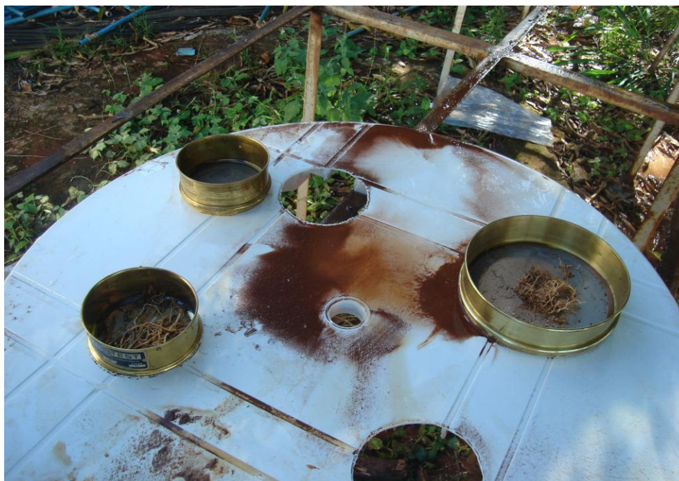
Figura 5.4. Raízes separadas na primeira etapa com auxílio de água.
