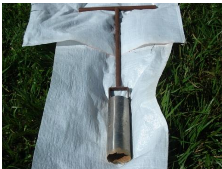
Figura 5.1. Trado tipo caneca adaptado para amostragem destrutiva de raízes junto com solo.
