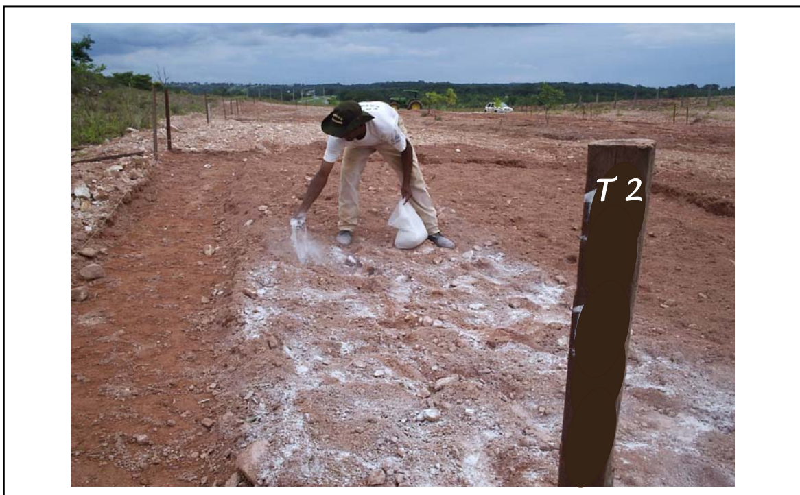
Figura 2. Operação de distribuição do calcário dolomítico, em parcela do tratamento T2 (adubação mineral), no experimento de recuperação de solo degradado, com aplicação de adubo mineral e doses crescentes de lodo de esgoto, à margem da Rodovia BR 060, km 124. Goianópolis, GO. Dezembro/2004.
