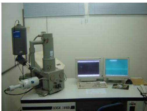
Figura 5.9 – Microscópio eletrônico de varredura utilizado na pesquisa
