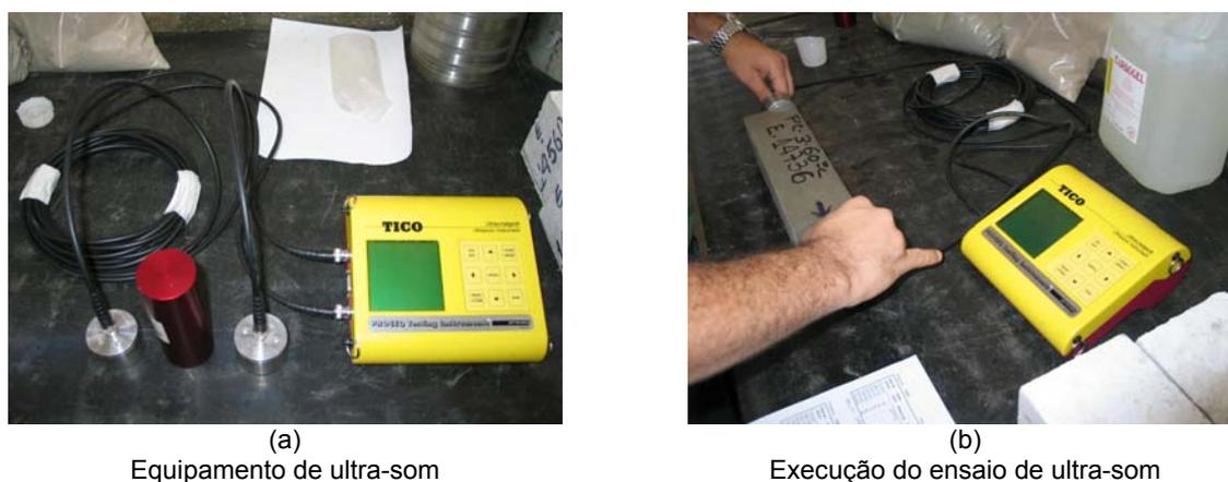
Figura 5.8 – Alguns detalhes do ensaio de ultra-som em prismas de concreto
