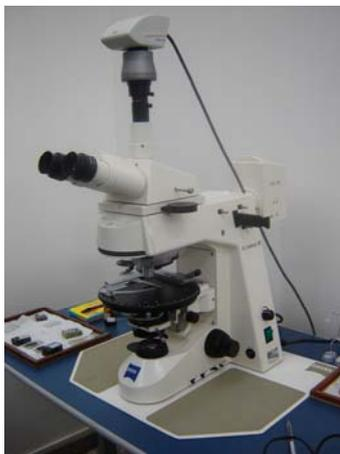
Figura 5.3 – Detalhe do equipamento (Leitz, modelo Ortholux 2 Pol-BK) utilizado na análise petrográfica
