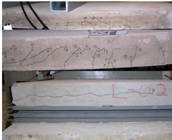
Figura 4.31 - Modo de ruptura típico de flexão no ensaio de flexão simples de lajes (ARAÚJO; OLIVEIRA JÚNIOR, 2013)
