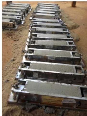
Figura 4.18h e 4.18i - Prismas serrados das placas e prismas moldados dos três tipos de argamassa estudado e o maquinário usado no ensaio de tração e compressão
