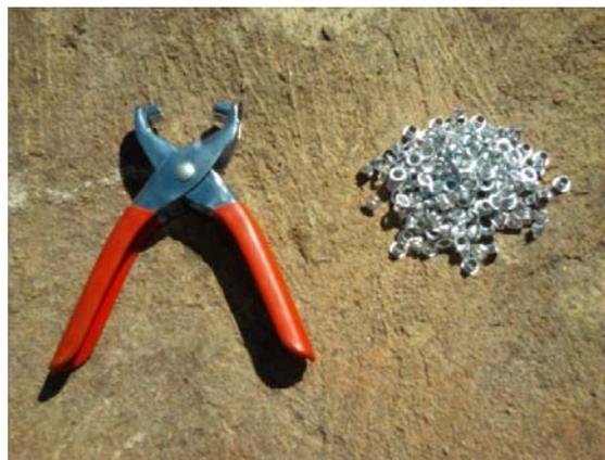
Em decorrência da inadequação do equipamento, foi então necessário desenvolver ferramentas específicas para viabilizar o uso do ilhós como elemento de fixação das embalagens. As Figuras 4.14a e 4.14b ilustram a última ferramenta criada, desenvolvida para
