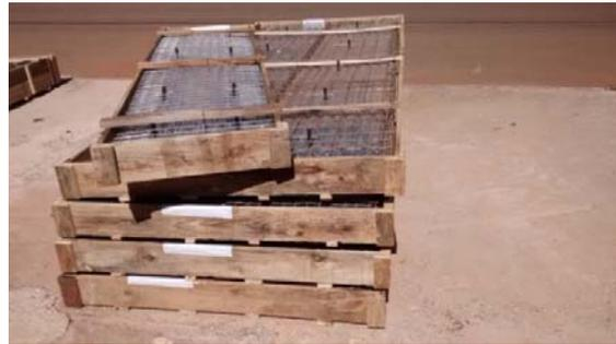
Nas Figuras 4.27a até 4.27f, revela-se o trabalho de moldagem dos pré-painéis já nas dependências do IPT, onde ficaram aguardando, em repouso, a cura e completo ganho de resistência por parte da argamassa estruturante, antes de serem submetidas aos testes.
