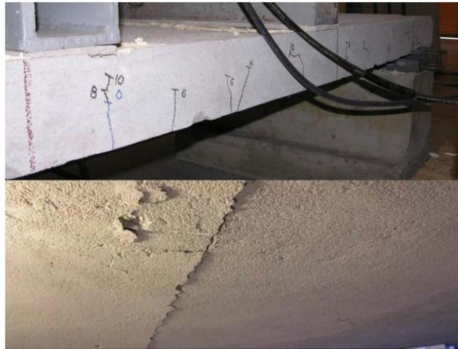
Logo, as duas configurações testadas não se mostraram adequadas, em termos de resistência e rigidez, para serem utilizadas como laje. A partir desta evidência, adotou-se para o sistema construtivo o padrão executivo e a teoria de cálculo de laje treliçada nervurada unidirecional moldada no local. O diferencial é que ao invés de lajotas ou mesmo isopor entre as nervuras utiliza-se placas de garrafas PET. Além disso, na parte inferior da laje executa-se argamassa armada com a tela galvanizada.
