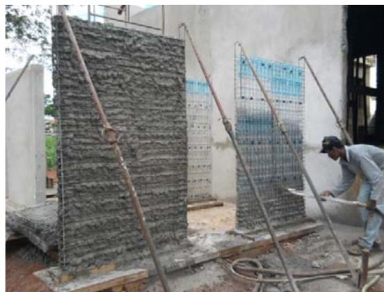
Figura 4.20e e 4.20f - Painéis de laje sendo preparados para ensaio (tela Q138, argamassa produzida em obra, projeção sistema canequinha)
