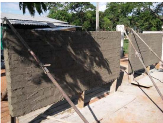
Figura 4.20g e 4.20h - Painéis de laje sendo preparados para ensaio (por cima a tela Q138 e concreto, por baixo a tela eletrossoldada galvanizada malha 5 cm x 5 cm Ø 2,76 mm e argamassa produzida em obra projetada no método bomba)
