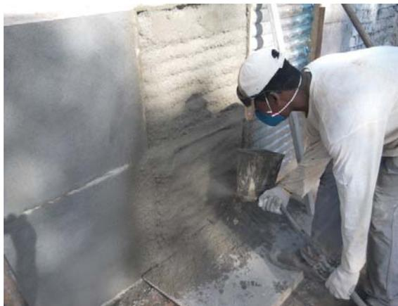
Figura 4.18d e 4.18e - Placas já endurecidas de argamassa ainda coladas nos painéis PET e as placas sendo serradas para obter os prismas de argamassa
