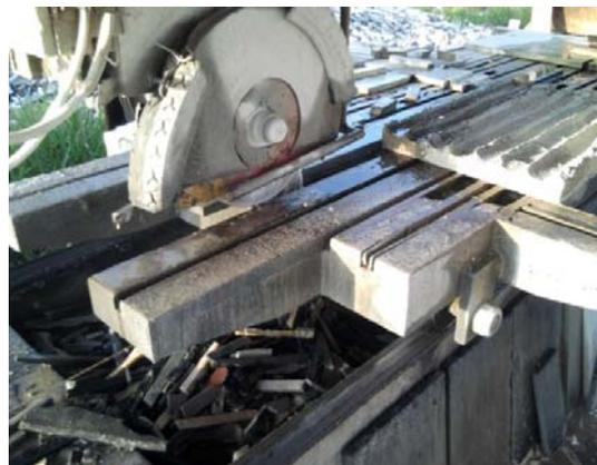
Figura 4.18f e 4.18g - Preparo dos prismas em moldes para os três tipos de argamassa estudado
