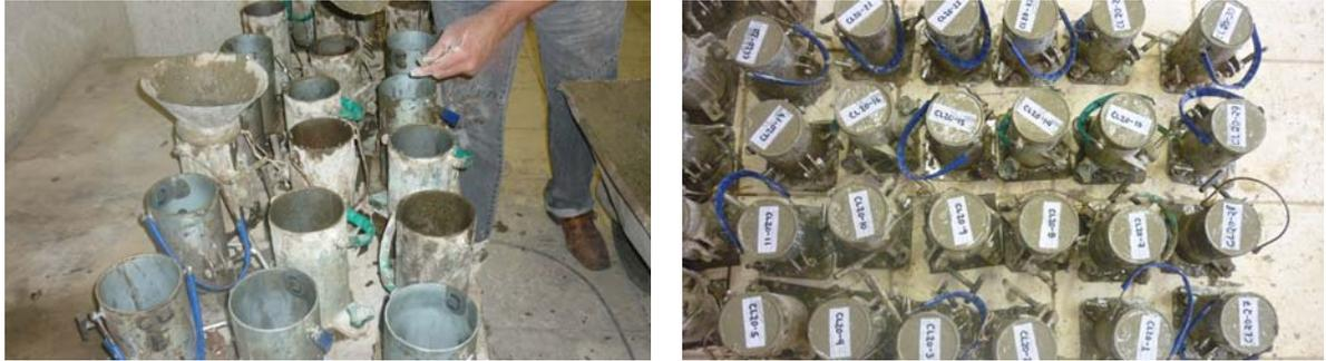
Figura 4.6. Moldagem dos corpos de prova cilíndricos.
