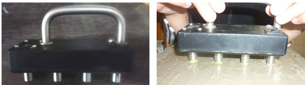
Figura 4.9. Equipamento utilizado nas medidas de resistividade elétrica do concreto.
