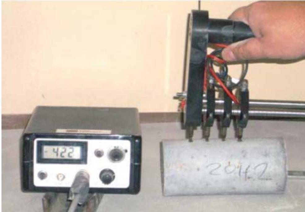
Figura 3.11 - Medição da resistividade elétrica do concreto utilizando o método dos eletrodos eqüidistantes 20 mm (FERNANDEZ, 2009).
