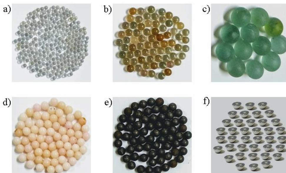
Figura 3.3. Sistema particulado utilizado: (a) esferas de vidro de 2 mm de diâmetro; (b) esferas de vidro de 4 mm de diâmetro; (c) esferas de vidro de 9 mm de diâmetro; (d) esferas de poliacetal de 4 mm de diâmetro; (e) esferas de aço cromo de 4 mm de diâmetro; (f) semiesferas de plástico de 4,69 mm de diâmetro volumétrico.
