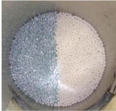
Figura 3.11. Vista superior do leito de partículas, exemplificando a alimentação de Configuração 2 (lado-a-lado).
