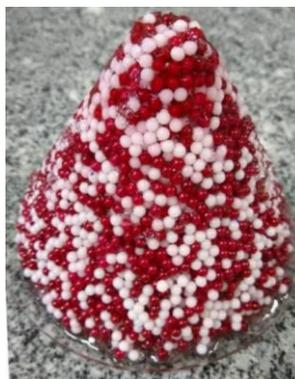
Figura 3.5. Exemplo de um cone de partículas solidificado com a solução de gelatina. Imagem referente ao experimento de Configuração A (Tabela 3.2).
