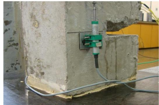
Os modelos foram instrumentados com dois transdutores lineares para medida do deslizamento na interface, conforme esquema da Figura 3.16a, um em cada face do corpo de prova (Figura 3.16b). Dessa forma, havia duas leituras do deslizamento da interface que foram utilizadas para determinar o deslizamento médio.
