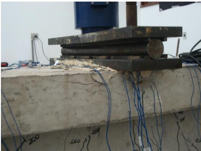
(b) face inferior no meio do vão com fissuras de flexão;
