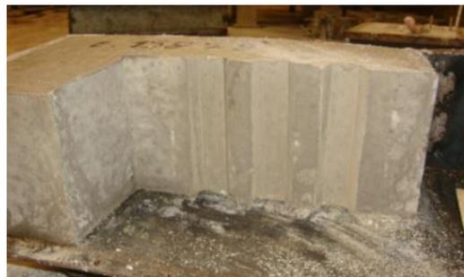
Nesse tipo de modelo, toda a superfície da interface entre as duas peças foi considerada superfície aderente, tendo, portanto, uma área de interface igual a 512 cm<sup>2</sup>. Dessa forma, toda essa área recebeu tratamento quanto à rugosidade.
