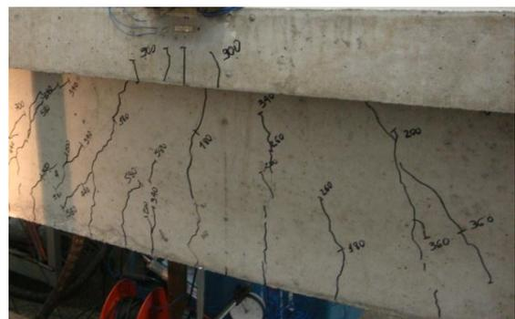
Na Figura 5.16 são mostrados três níveis de carregamento com os respectivos panoramas de fissuração da viga composta VC1. Nesse caso, as forças escolhidas foram 240 kN, 480 kN e 560 kN, ou seja, 35%, 69% e 81% da força máxima resistida pela viga ( $F_{m\acute{a}x}$ ), respectivamente. Nas figuras pode-se verificar que a formação das fissuras se deu de forma ascendente, da face inferior da viga em direção à face superior, chegando, às vezes, a atingir a região de interface viga/laje.
