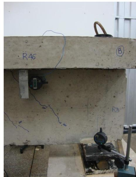
Durante a execução dos ensaios de flexão nas vigas, foram realizados ensaios de fotoelasticidade em uma das faces laterais das vigas, com cerca de um metro de comprimento por 38 cm de altura (Figura 3.31). A realização desse procedimento teve como objetivo corroborar com as análises da formação da biela de compressão na viga pré-moldada.
