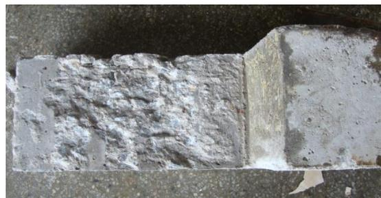
Figura 4.12 – Deslizamento na interface – Modelos com CC.
