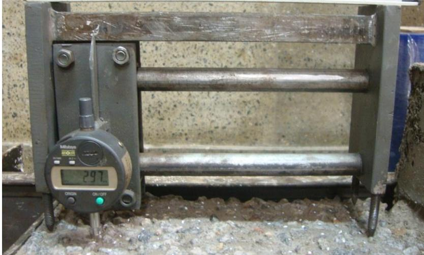
Figura 3.13 – Malha para leitura da rugosidade (210 mm x 120 mm).
