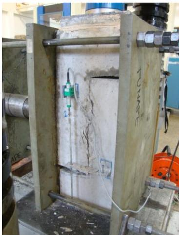
(b) Superfície da interface após a fissuração – Detalhe da ruptura das chaves de cisalhamento.
