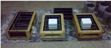
b) concretagem do primeiro nicho – detalhe da instrumentação e do conector.
