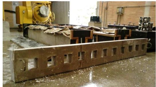
Para a obtenção da superfície rugosa na região dos nichos, assim como nas demais etapas do programa experimental, foi empregado o aditivo retardador superficial de pega (ARSP) aplicado com a ajuda de pedaços de tecido cortados nas dimensões dos nichos (Figura 3.27d). No dia seguinte à concretagem da viga, retirou-se o tecido, procedendo-se a lavagem dos nichos com escova de aço e água, formando assim a textura rugosa. O cronograma de concretagem das vigas compostas é apresentado na Figura 3.28.
