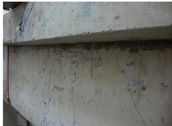
Na Figura 5.17f pode-se notar que as fissuras que surgiram na face inferior da viga alcançaram a interface, na região dos nichos. Diferentemente do verificado no trabalho de Araújo (2002), onde o autor verificou uma concentração de tensões nos cantos inferiores dos nichos devido à presença das chaves de cisalhamento, no caso do tratamento com ARSP tal comportamento não foi observado. Essa diferença nesse trabalho se deve, principalmente, à menor resistência da ligação.
