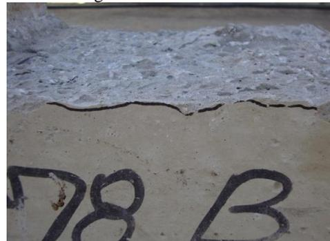
No modelo 2 (Figura 4.7b), observou-se ruptura das mini-chaves de cisalhamento antes que ocorresse a expansão, ou seja, a tendência à dilatação. Na Figura 4.8 são mostrados detalhes da ruptura dos modelos MCC1 e MCC2. Na Figura 4.8a tem-se o detalhe da interface de ligação do modelo MCC1 após a ruptura, mostrando a não ruptura das mini-chaves. E, na Figura 4.8b, é apresentado o panorama de fissuração formado durante o ensaio do modelo MCC2.
