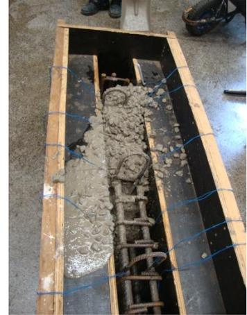
d) Superfície da viga pré-moldada após concretagem – detalhe da aplicação do ARSP na região dos nichos.
