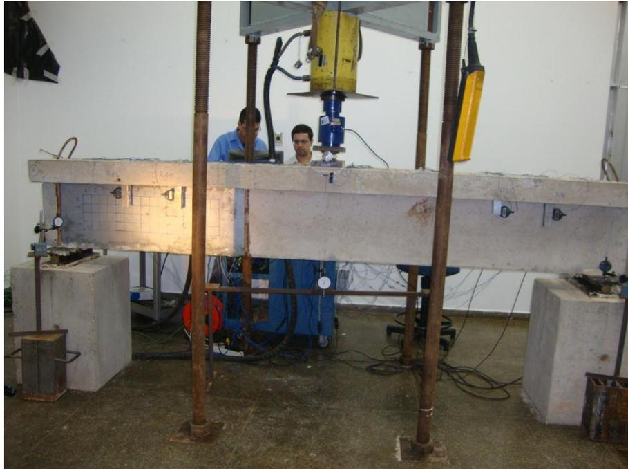
b) Detalhe da célula de carga, atuador hidráulico, extensômetro no concreto e relógio comparador no meio do vão para leitura da flecha.
