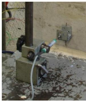
c) Detalhe dos extensômetros elétricos.
