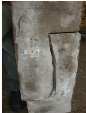
(b) Vista da interface no modelo após ruptura.
