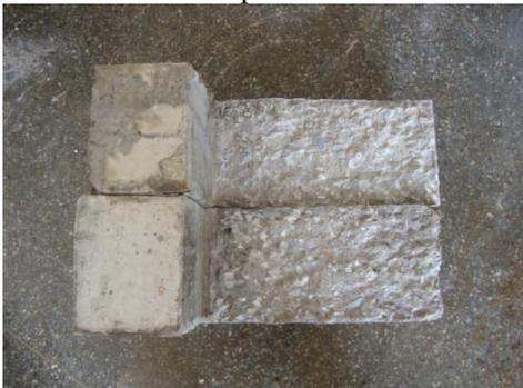
(b) Vista lateral da interface após ruptura – Detalhe da rugosidade da interface.
