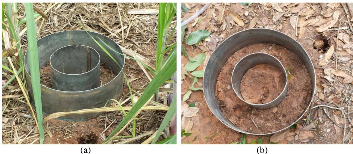
**Figura 4.2.** Anéis concêntricos implantados para avaliação da movimentação de potássio sob regime hídrico controlado: (a) Neossolo Quartzarênico sob cultivo de cana-de-açúcar; (b) Neossolo Quartzarênico sob Cerrado. Mineiros – GO (2013)
