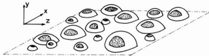
Figura 2.45 - (a) Corpo de concreto fissurado, (b) plano Z de intersecção e (c) trecho representativo (WALRAVEN e REINHARDT,1981)
