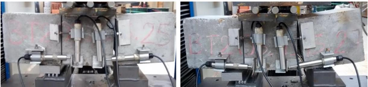
Figura 4.31 - Ruptura dos corpos de prova do traço 3 submetidos ao ensaio de cisalhamento
