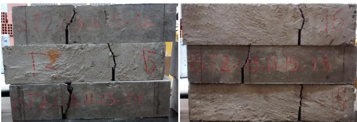
Figura 4.20 - Ruptura dos corpos de prova do traço 3 submetidos ao ensaio do modo misto de fratura
