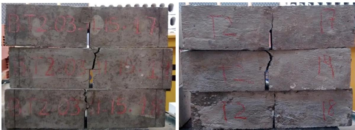
Figura 4.17 - Ruptura dos corpos de prova do traço 3 submetidos ao ensaio do modo I de fratura
