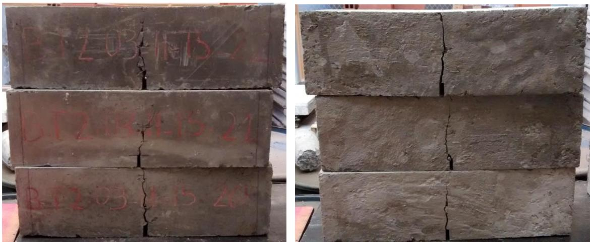
Figura 4.7 - Forma de ruptura dos corpos de prova do traço 3 (1,5% de fibras) sujeitos a flexão
