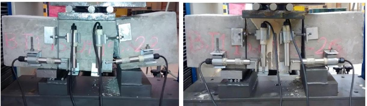
Figura 4.32 - Plano de cisalhamento do: (a) traço 1, (b) traço 2 e (c) traço 3
