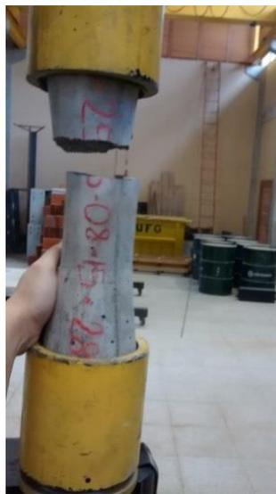
Figura 4.3 - Forma de ruptura dos corpos de prova do ensaio de tração direta do traço 2
