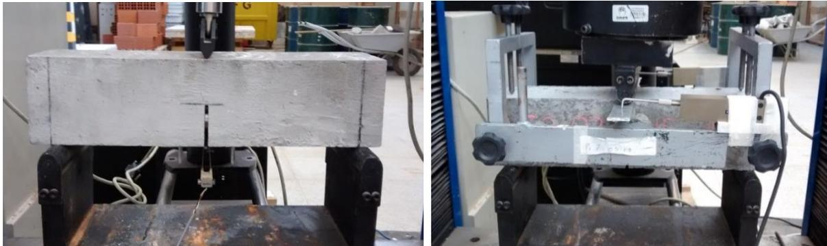
A energia de fratura do concreto para os corpos de prova com fibras é calculada de acordo com a equação (3.5) recomendada pela RILEM 50-FMC (1985):
