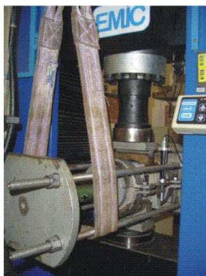
Os corpos de prova prismáticos tinham dimensões de 150 mm x 150 mm x 600 mm. O ensaio foi baseado no trabalho de Mirsayah e Banthia (2002). Os corpos de prova foram entalhados em 15 mm ao longo do perímetro da seção transversal na região onde se esperava a ruptura
