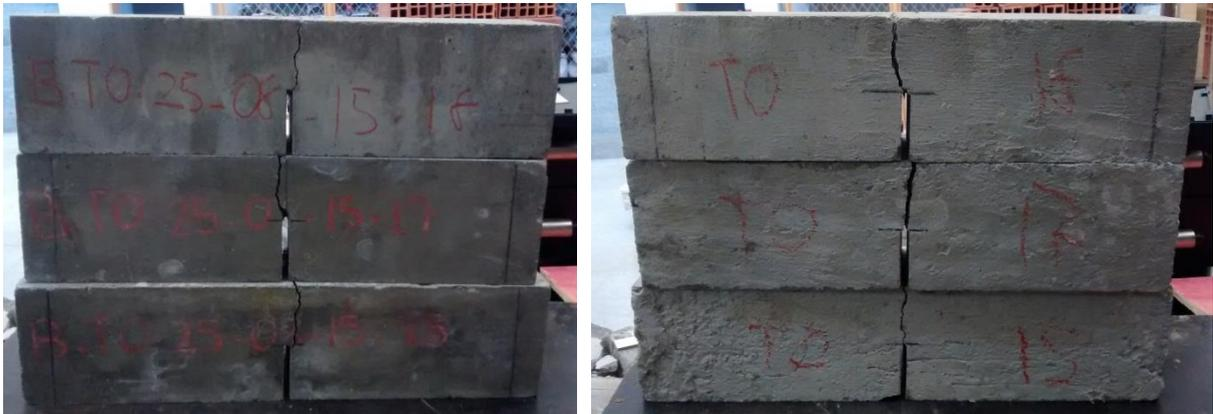
Figura 4.6 - Forma de ruptura dos corpos de prova do traço 2 (0,5% de fibras) sujeitos a flexão
