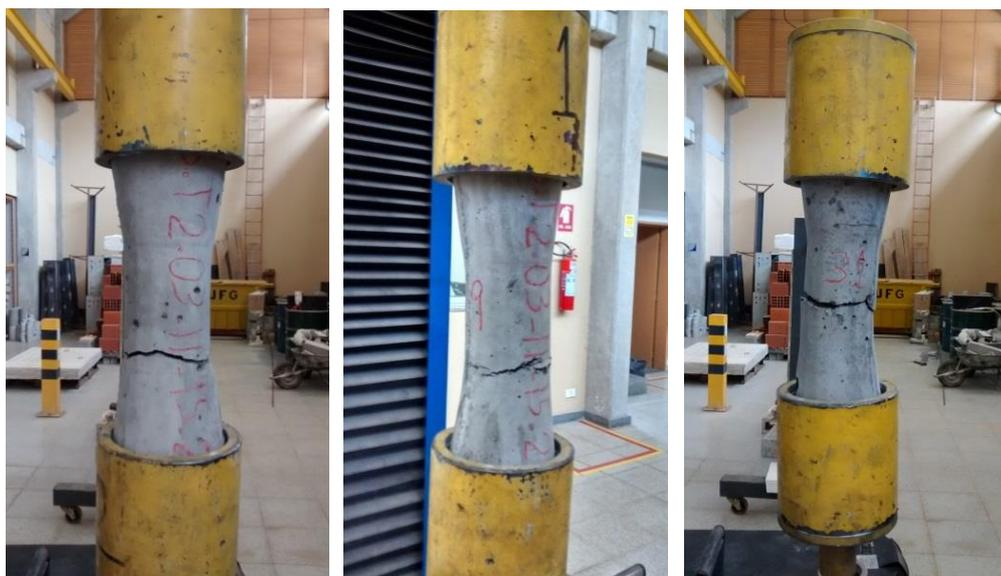
Figura 4.4 - Forma de ruptura dos corpos de prova do ensaio de tração direta do traço 3
