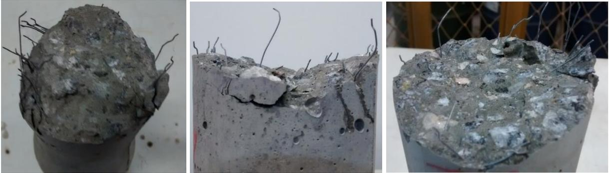
Figura 4.12 - Seção dos corpos de prova com 1,5 % de fibras, depois de rompido, submetidos ao ensaio de tração direta
