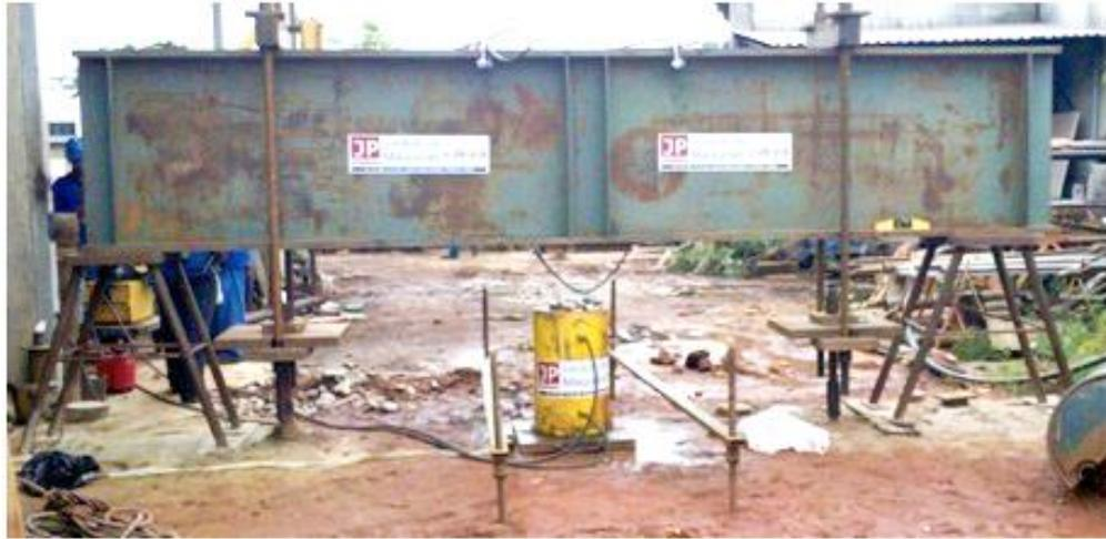
Figura 5.26 ó Fixação dos sensores ao longo da estaca prova: (a) sensores instalados em seções transversais diferentes; (b) sensores próximos à cota de arrasamento do bloco; (c) sensores ao longo da estaca.
