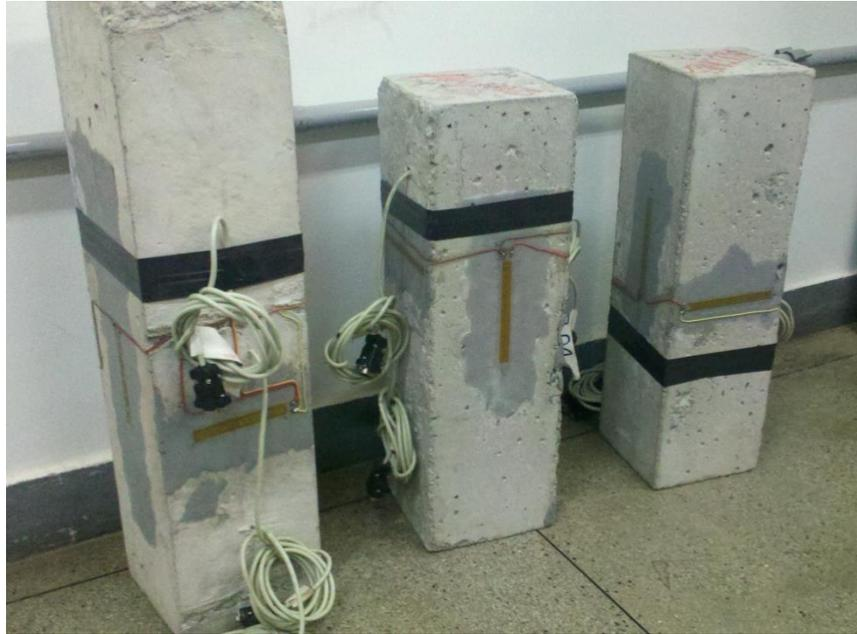
Figura 6.16 ó Testes de carga sobre pilarete 01: sensores de barra, imersão, e extensômetros de face.
