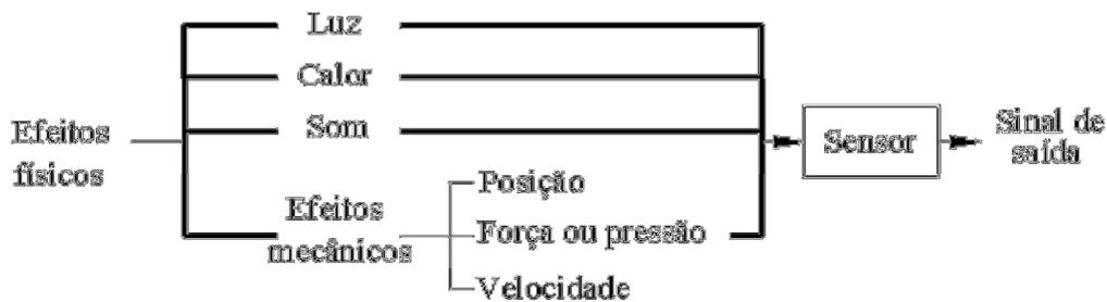
As formas básicas de instrumentação podem ser feitas utilizando os seguintes princípios de funcionamento de sensores:
