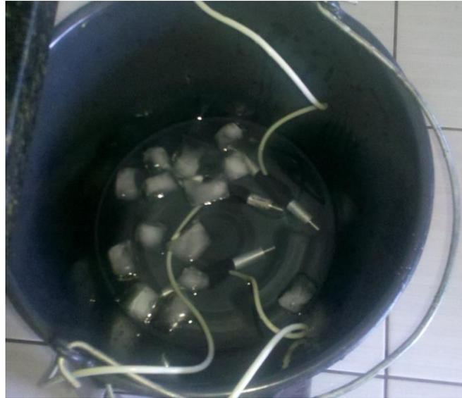
Figura 5.20 ó Deformações dos sensores submersos submetidos a variações instantâneas de temperatura.
