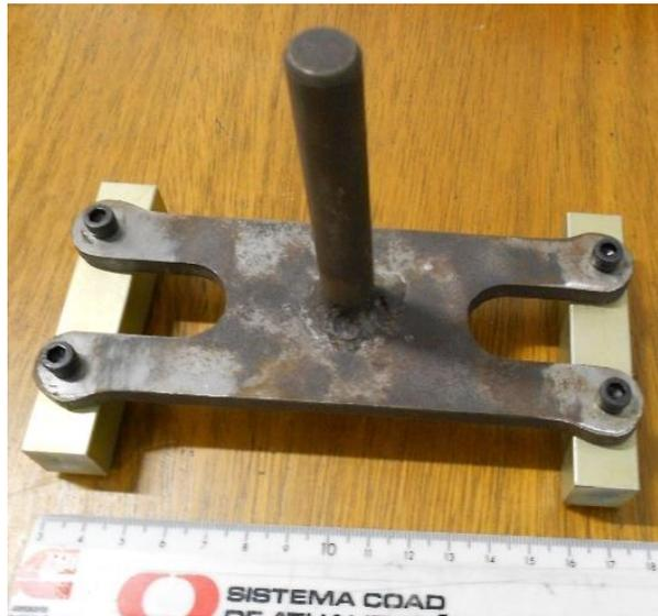
O sensor de imersão foi instalado usando os vergalhões adjacentes para posicionamento e centralização, tendo o cuidado e a atenção, durante a concretagem do pilarete, de evitar danos que alterassem o alinhamento do sensor. A Figura 6.3 mostra esquema de montagem adotado.
