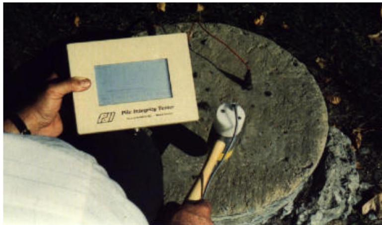
O uso mais comum do ensaio de integridade (PIT) é para detectar falha na concretagem de estacas de concreto moldadas *in loco* ou danos resultantes da cravação de estacas pré-moldadas de concreto. No entanto, o ensaio pode também ser usado para determinar ou confirmar o comprimento de estacas de concreto. Se a estaca possuir um dano severo, ou mesmo uma emenda construtiva, que não permita a transmissão da onda, não há como avaliar o estado da estaca abaixo deste ponto.
