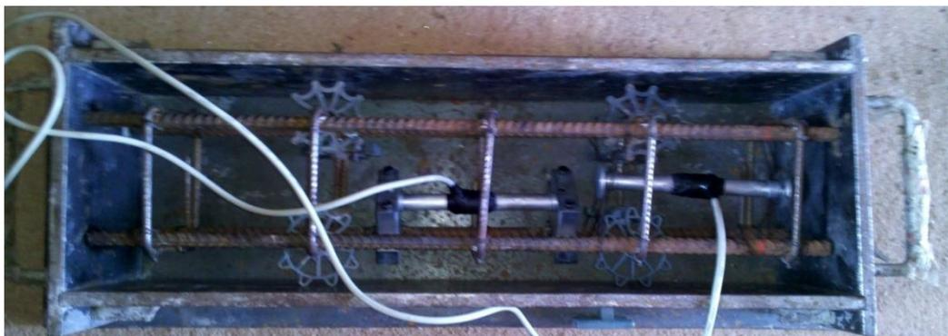
Para que os sensores fossem instalados corretamente, de modo a não interferir no comportamento estrutural, foi necessário cuidado e atenção para se evitar, por exemplo, danos provenientes da soldagem. As chapas, para a instalação dos sensores de barra, foram soldadas na armadura da estaca empregando um gabarito específico, desenvolvido para esta pesquisa, com a finalidade de garantir a distância correta e o alinhamento para a fixação dos sensores de barra, como mostrado na Figura 6.2.
