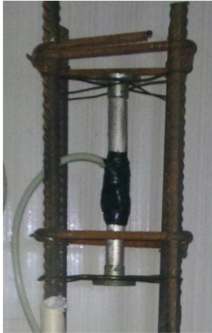
Figura 6.4 - Ensaios de ciclos de carga pilarete 01 com extensômetros na face.
