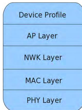
**Figura 2.6:** Camadas do protocolo ZigBee
