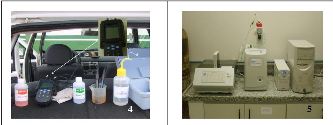
**Figura 4 e 5** - Aparelho Hach Sension 156 e aparelho ICS-90 ION Cromatography System, respectivamente (MACHADO, 2007).
