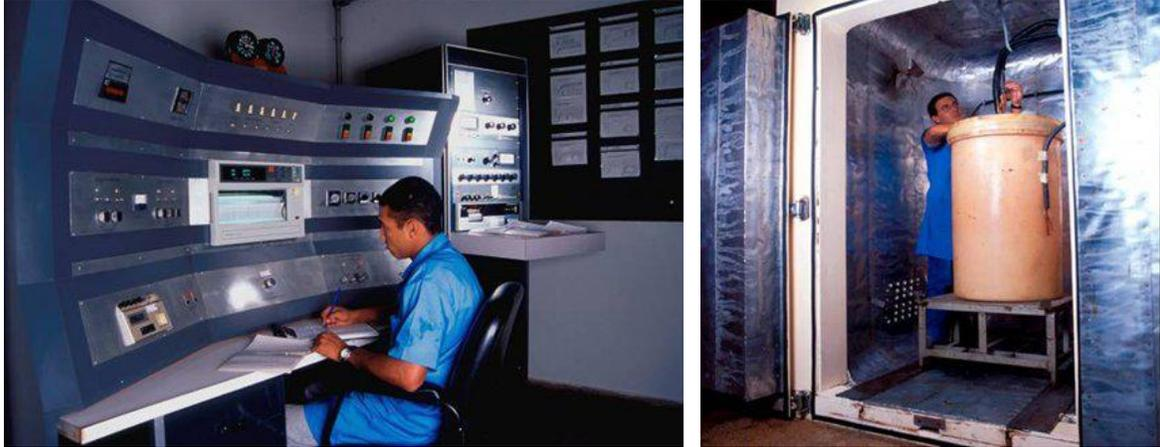
Figura 4.3: a) Calorímetro adiabático - aparelhagem de medição; b) colocação da amostra. (FURNAS, 2007)
