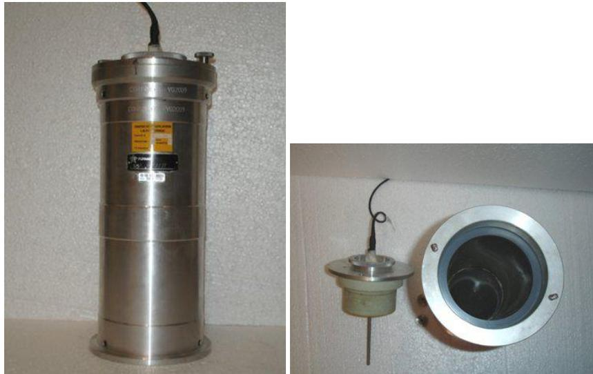
Figura 2.3: Calorímetro semi-adiabático, chamado Garrafa de Langavant. Laboratório de Concreto de FURNAS.
