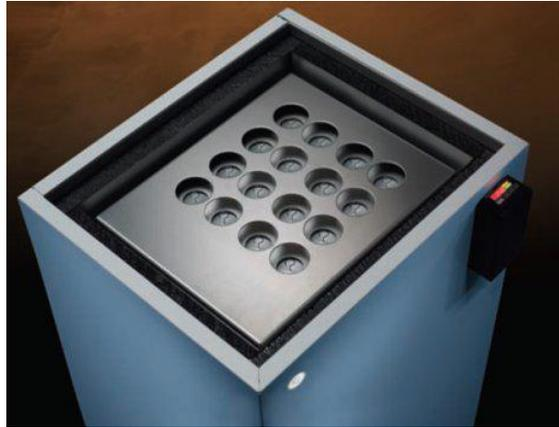
Figura 2.4: Foto de calorímetro isotérmico para cimento modelo TAMAir. (TA Instruments, 2009).
