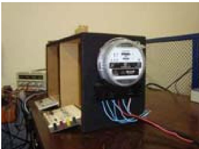
Fig. B-8 – Medidor trifásico do tipo eletrônico.
