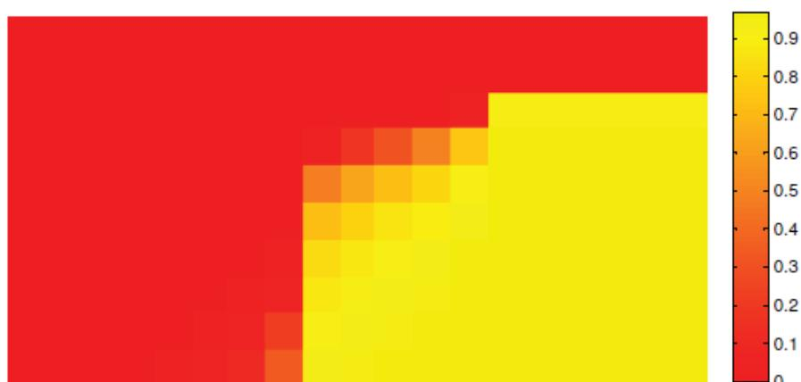
Analisando essas figuras, é possível perceber que os prismas com maior concentração de fibras resistem a maiores carregamentos com consequente ampliação da região danificada. Isto se deve ao efeito de grampeamento das fissuras pelas fibras na região de tração.
