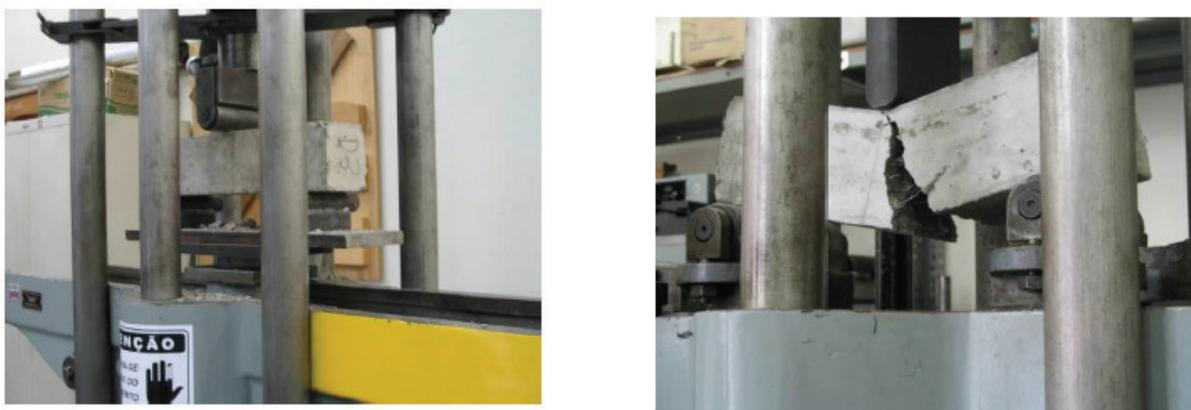
Por fim, a Figura 2.32 apresenta um prisma no momento do ensaio e logo após a sua ruptura por flexão.
