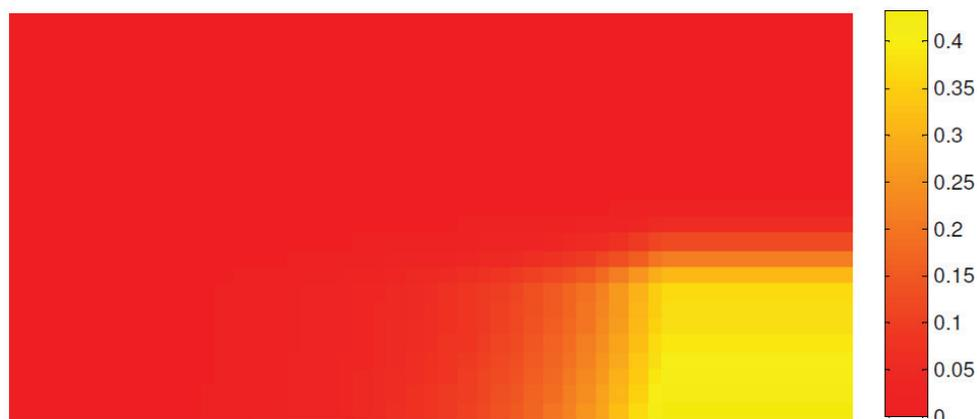
Figura 5.41 - Danificação numérica por elemento na 1ª camada da viga
