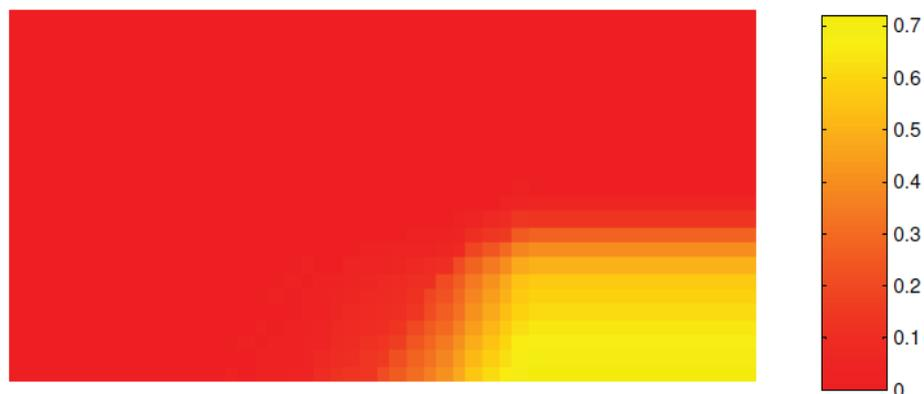
Figura 5.20 - Avaliação a 63 kN do dano a tração na viga V2 de concreto com concentração de 2,00% de fibras
