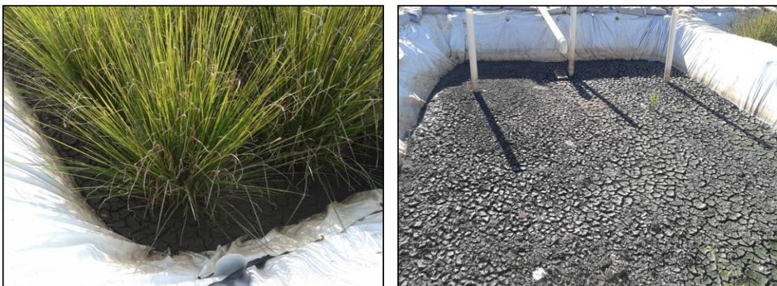
**Figura 41** Acúmulo de lodo no SAC (esquerda) e no tanque controle após quatro semanas de aplicações do RFTS.
