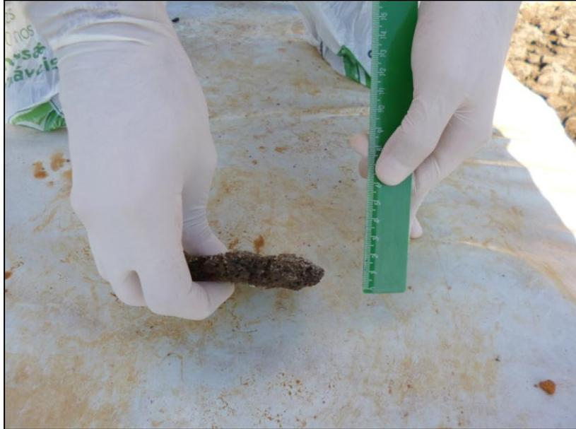
**Figura 27** Medição da espessura da camada de lodo acumulada na superfície do SAC.
