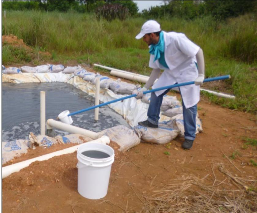
**Figura 24** Procedimento de amostragem do resíduo no ato da sua disposição no SAC.
