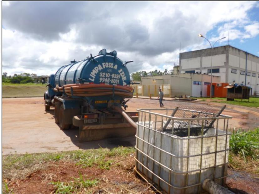
**Figura 25** Procedimento de descarga do RFTS na caixa de recepção do sistema experimental de tratamento.
