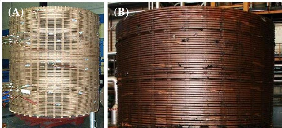
**Figura 3.** Isolante sólido de um transformador elétrico em boas condições (A); Isolante sólido degradado (B) [16,17].
