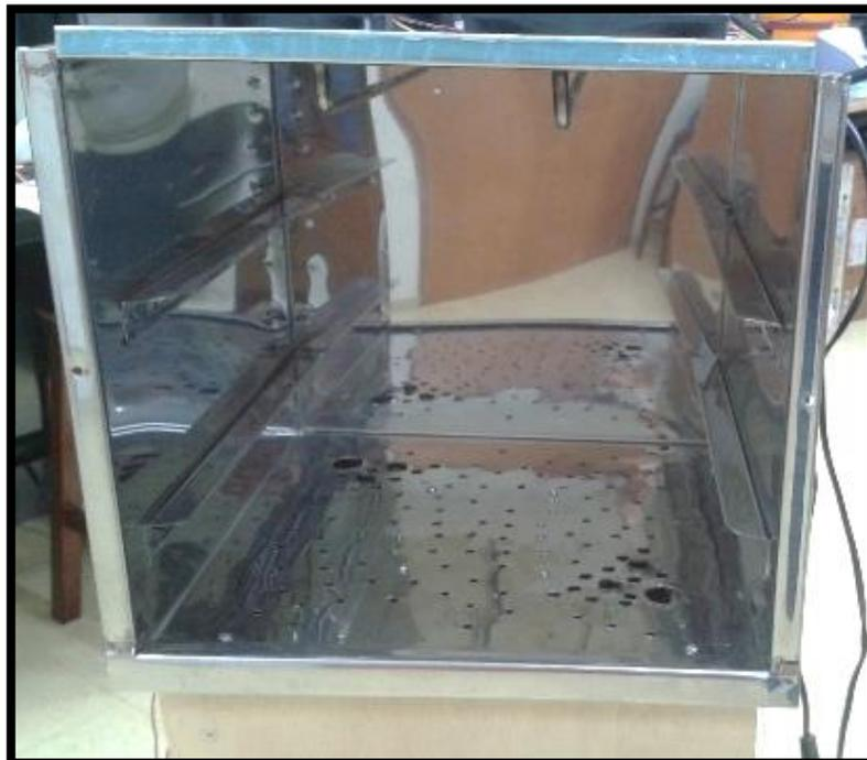
Com estes ajustes, usando-se como fonte de aquecimento uma resistência elétrica em espiral e, para convecção forçada, dois *coolers*, instalou-se um sensor de temperatura no interior do compartimento de aquecimento. Registrou-se uma temperatura de 60 °C em apenas 5 minutos de funcionamento.
