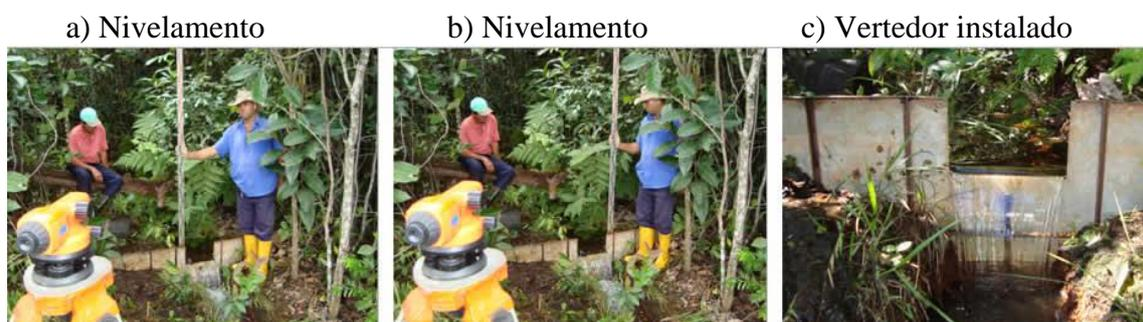
**Figura 12.** Processo de medição de vazão empregado na vereda T1VP, por meio do vertedor retangular contraído de parede delgada.
