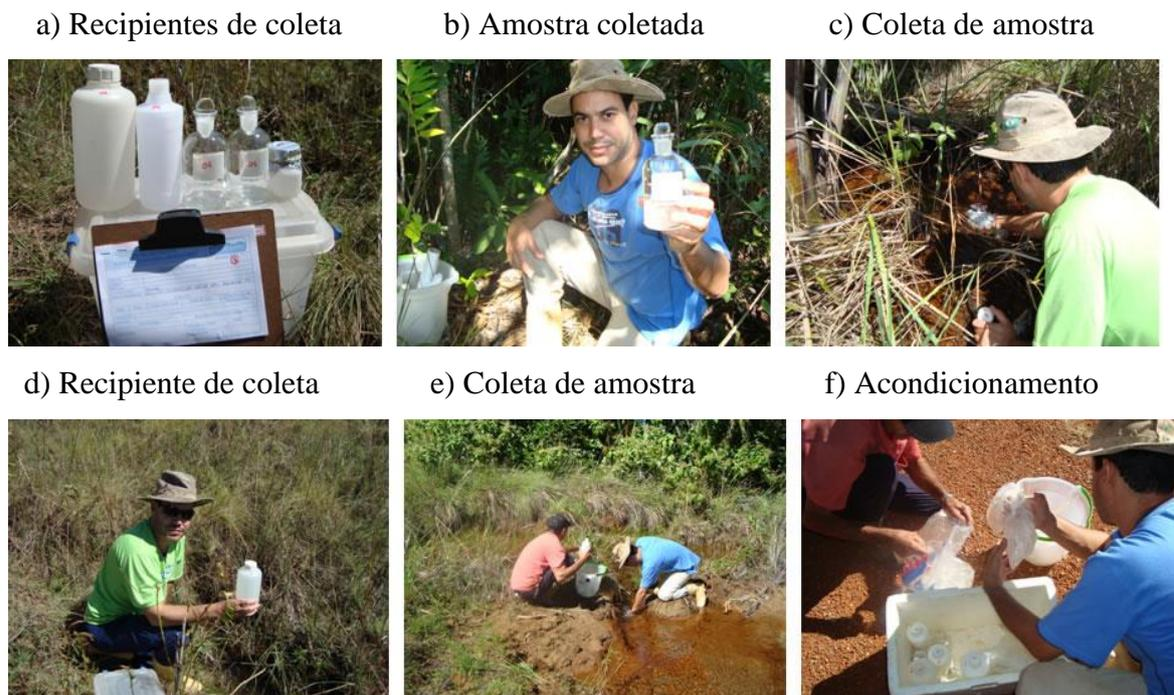
**Figura 13.** Recipientes, processo de coleta e acondicionamento das amostras de água das veredas estudadas.
