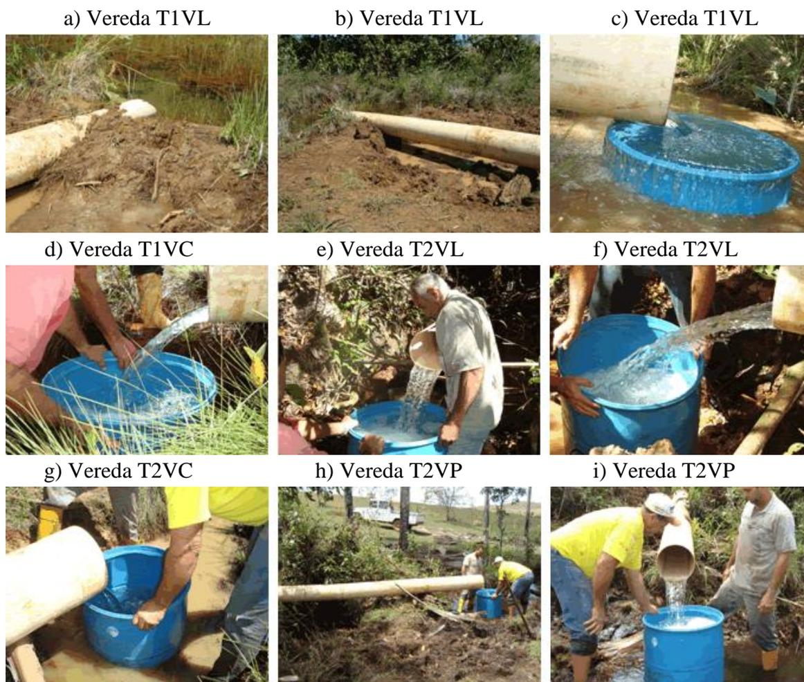
**Figura 10.** Processo direto de medição de vazão nas veredas T1VL, T1VC, T2VL, T2VC e T2VP.
