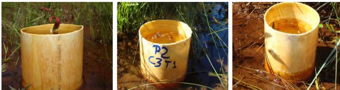
**Figura 21.** Exemplos de poços de observação com nível de água acima do solo.
