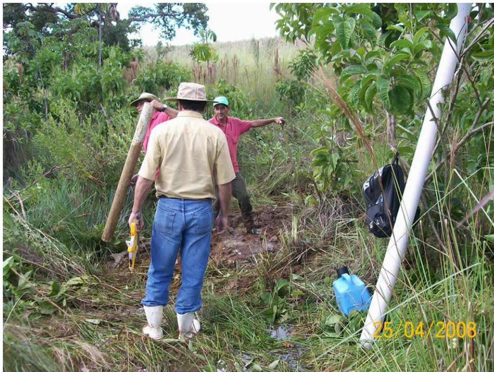
**Figura 9.** Instalação de poços de observação do nível do lençol de água ao longo do transecto da vereda T1VL.
