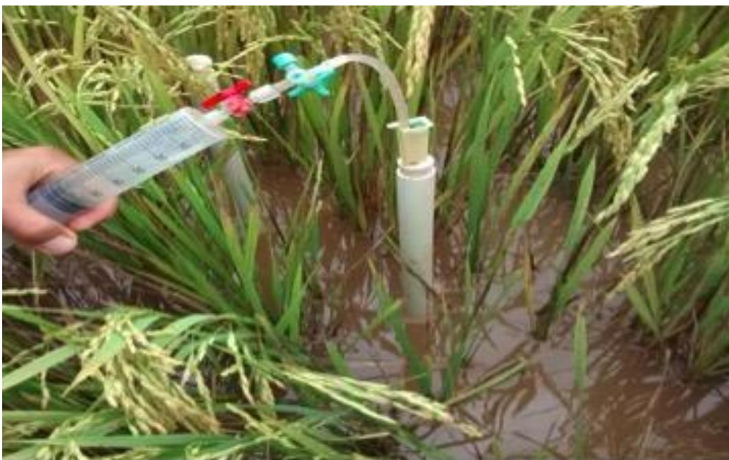
**Figura 3.1** Extratores de Solução do solo instalados no campo.
