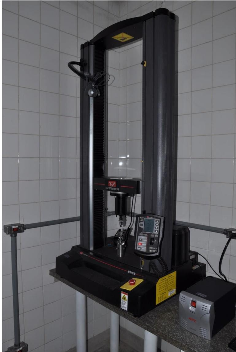
Figura 9. Máquina de ensaio universal Instron 5965.
