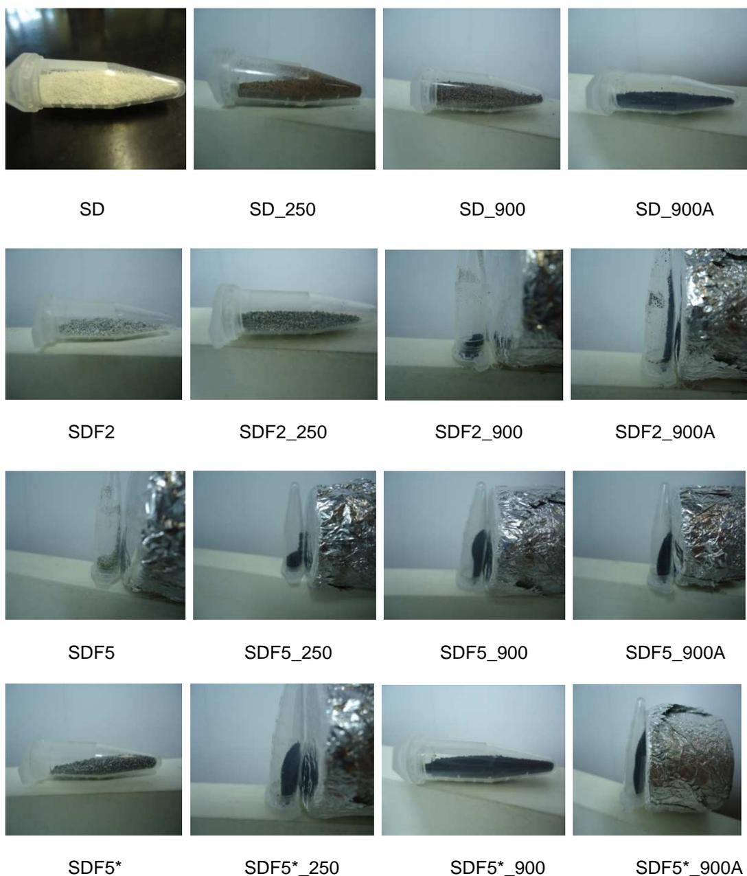
**Figura 4.7** - Fotos das matrizes sintetizadas: copolímero SD, compósitos SDF2, SDF5 e SDF5\* e seus respectivos produtos após cada etapa do tratamento térmico.
