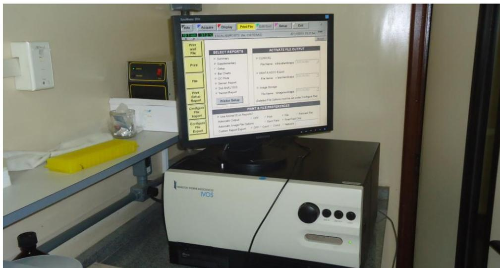
FIGURA 1- Equipamento Computer Assisted Semen Analysis (CASA) utilizado para avaliar os parâmetros cinéticos de movimentos das amostras de sêmen equino
