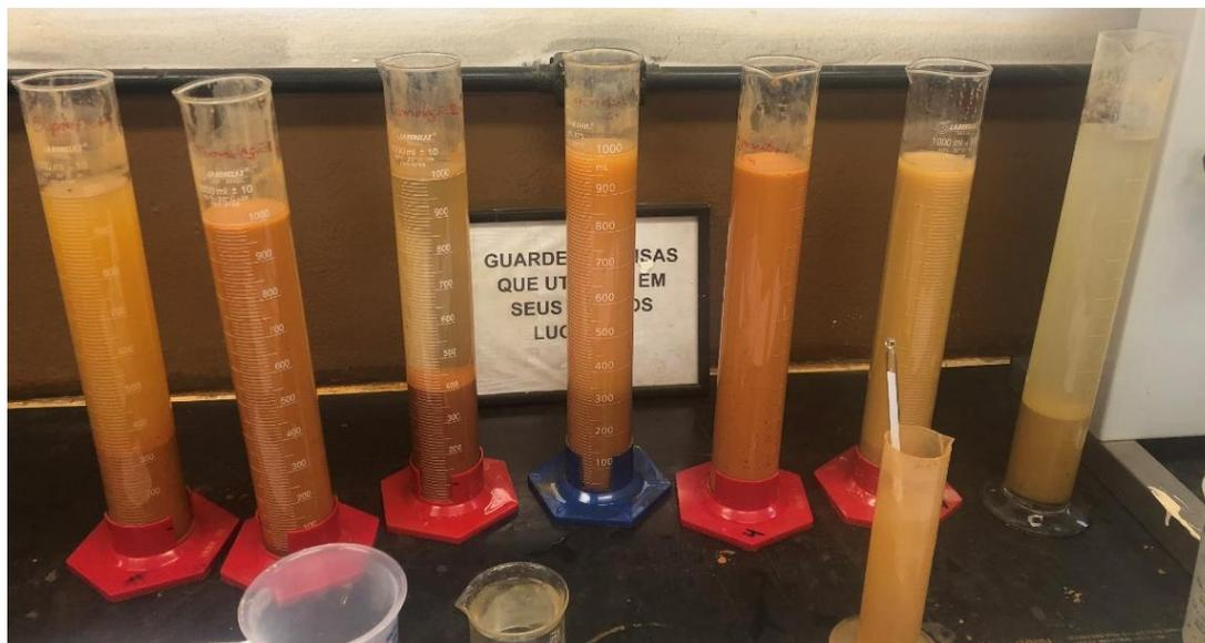
**Figura 4.12-** Ensaio de granulometria da água no solo conforme a ABNT NBR 13969:1997.
