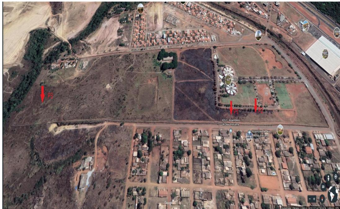
**Figura 4.6-** Localização dos poços de monitoramento - 1, 2, 3. Distância: P1 e P2 90m - poço P2 ao poço P3 830m
