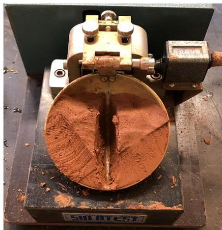
**Figura 3.14** - Limite de Liquidez (LL) – aparelho de Casagrande
