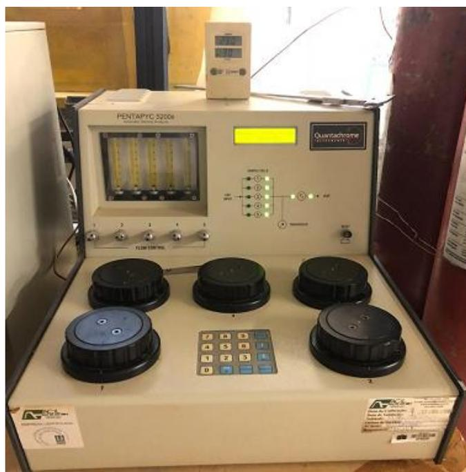
**Figura 4.15** - Pentapicnômetro – Laboratório de Geotecnia da Universidade de Brasília
