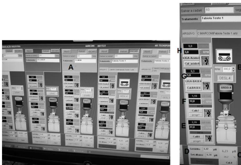
Figura 5. A, tela de trabalho do programa de computador demonstrando os cinco frascos; B, controle de velocidade da rotação do motor giratório; C, registro de pH e temperatura; D, intervalo de pH programável; E, controle velocidade bomba peristáltica solução tampão; F, controle velocidade bomba peristáltica filtro; G, controle bomba peristáltica hidróxido de sódio; H, controle velocidade bomba peristáltica ácido clorídrico.
