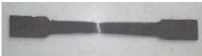
**Figura 4.1 – Modo de ruptura do corpo de prova no ensaio à tração**
