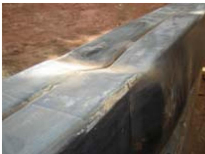
**Figura 4.3 – Ruptura por plastificação da mesa comprimida**
