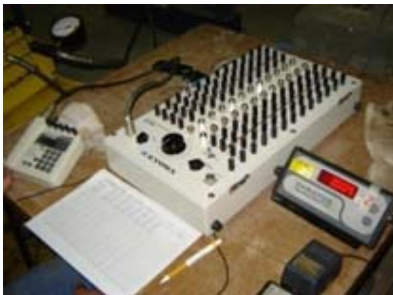
**Figura 3.13 – Sistema de aquisição de dados dos extensômetros e da célula de carga**
