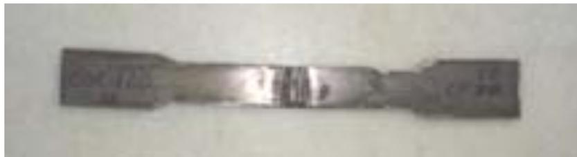
**Figura 3.4 – Corpo de prova para caracterização da solda, antes da realização do ensaio**
