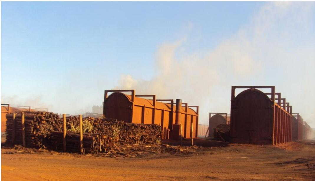
**Imagem 09: Fornos em carvoaria do tipo moderna com empilhamento da madeira a ser carbonizada.**
