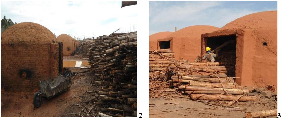
**Figura: 5** -fornos de alvenaria, denominado “rabo-quente” em processo de carbonização ou resfriamento, floresta de eucalipto e pátio de reserva do carvão a ser transportado; **2-** fornos de alvenaria em carvoaria de pequeno porte, madeira (eucalipto cortado por moto-serra) para ser carbonizada e carrinho de mão para traslado do carvão; **3** –trabalhador abastecendo um forno de alvenaria de uma carvoaria de médio porte, cuja madeira foi cortada por maquina.
