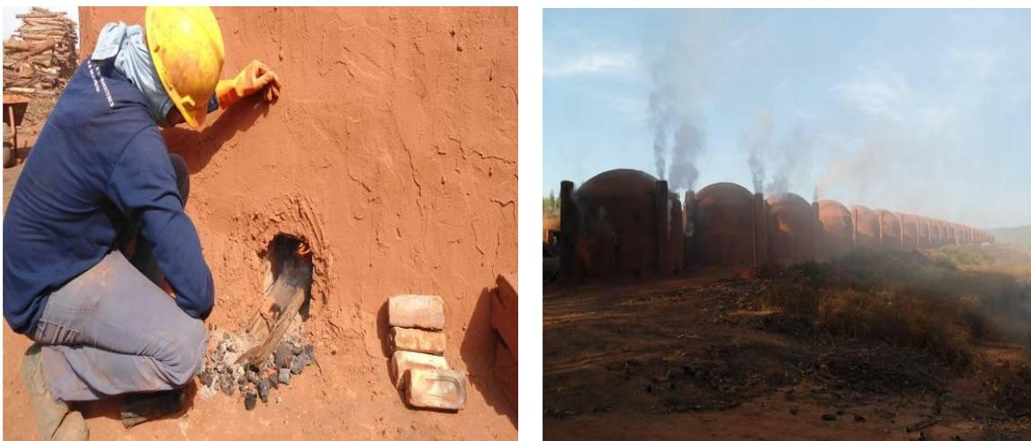
**Figura 06: 1) Trabalhador aciona o processo de carbonização, ascendendo o forno para dar início ao processo. 2) Fornos em processo de carbonização do carvão.**
