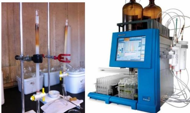
Legenda: Coluna cromatográfica preenchida com sílica (1); Sistema de purificação flash (2). Fonte: Autor.
