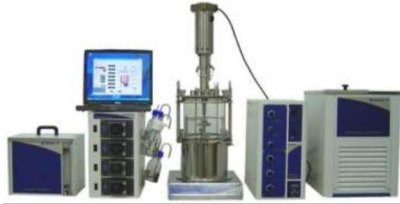
Legenda: Biorreator de Tanque agitado Tecnal®. Fonte: *site Tecnal®*.
