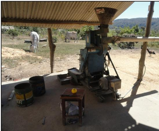
Figura 23. Máquina de Secar e Descascar Arroz.
