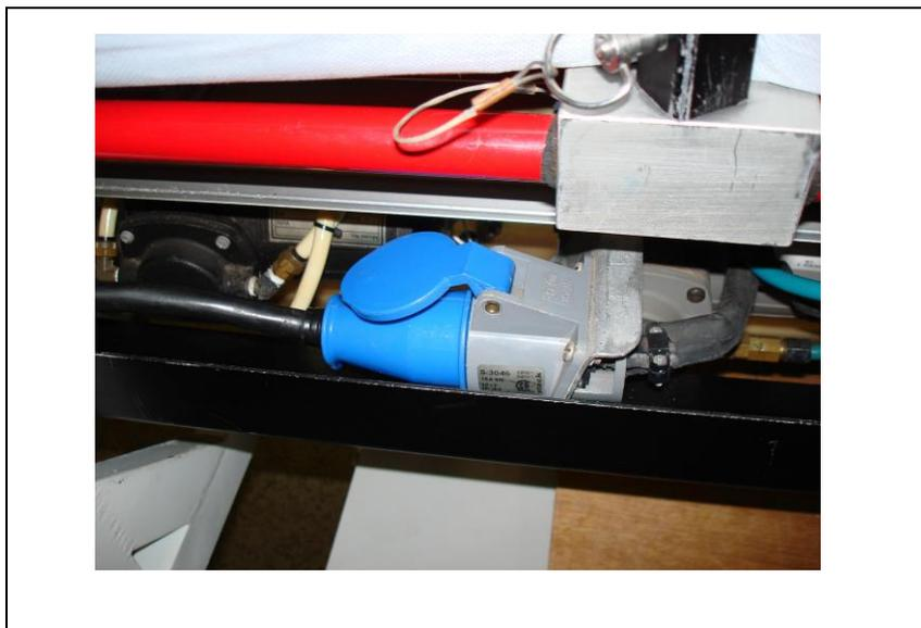
**Figura 5.9** - Conector Vindo da Alimentação Elétrica da Aeronave.
