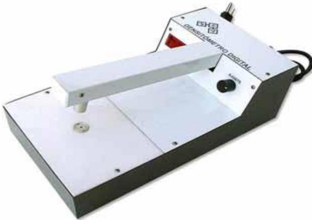
Figura 1 – Fotodensitômetro para medidas de densidade óptica nos filmes (imagem do penetrômetro), para controle de qualidade do processamento radiográfico
