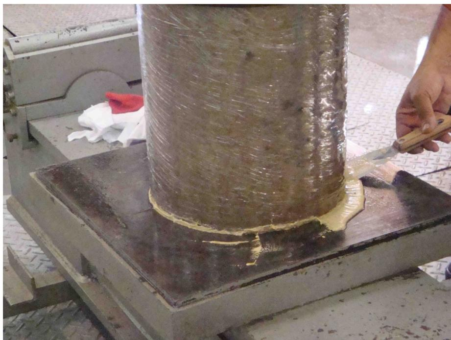
Figura 3. 7 – Retirada do excesso de gesso pedra durante o procedimento de capeamento do corpo de prova de 300 mm de diâmetro
