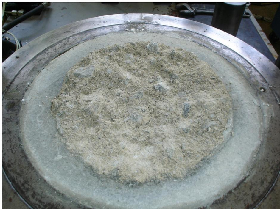
Figura 4. 30 – plano de ruptura imposto pelo ensaio de cisalhamento direto após ruptura de um corpo de prova de CCR de 300 mm de diâmetro por 300 mm de altura sob tensão normal de 1,5 MPa.
