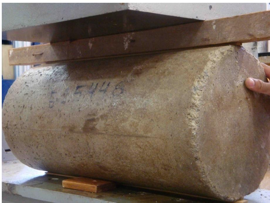
Figura 3. 8 – Preparação do corpo de prova de CCR de 300 mm de diâmetro para ser ensaiado à tração por compressão diametral
