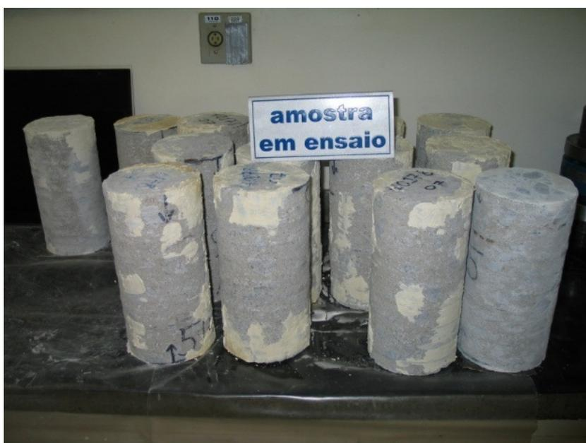
Figura 3. 9 – Corpos de prova preparados para serem ensaiados à compressão triaxial
