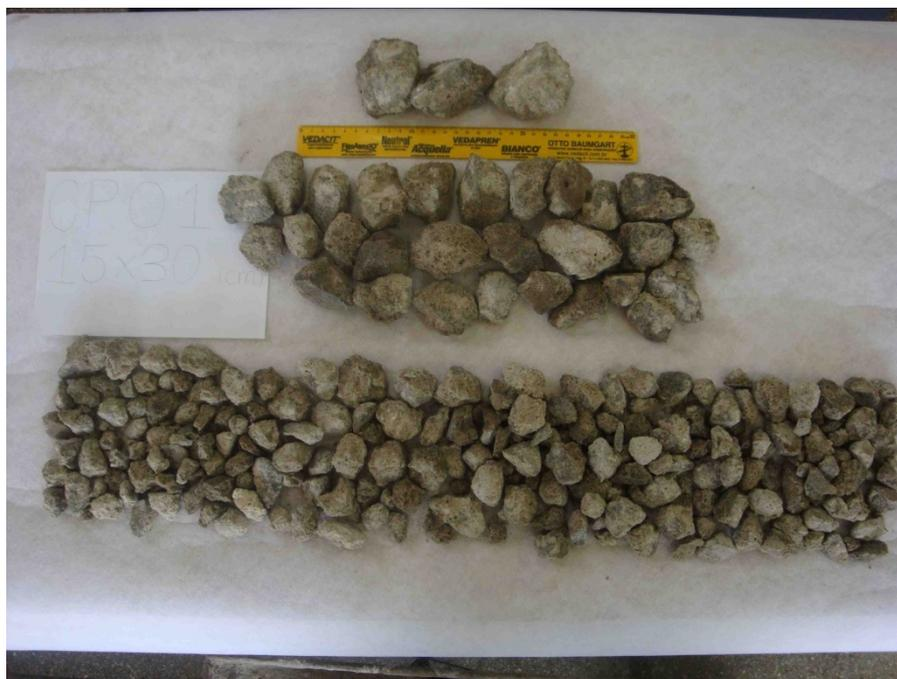
Figura 3. 16 – Quantidade de agregados graúdos extraídos de um dos corpos de prova de 150 mm de diâmetro
