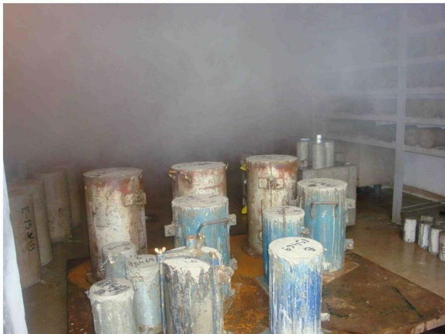
Figura 3.6 – Corpos de prova na câmara úmida
