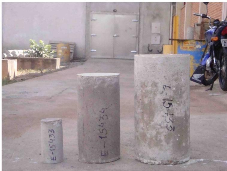
Figura 4. 8 – Corpos de prova de diferentes dimensões após a ruptura por compressão uniaxial (simples)
