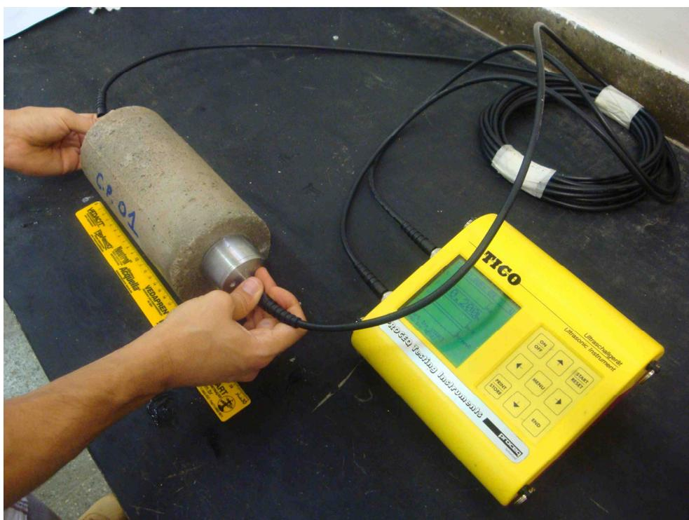
Figura 3. 10 – Execução do ensaio de ultra-som em corpo de prova de CCR de 100 mm de diâmetro
