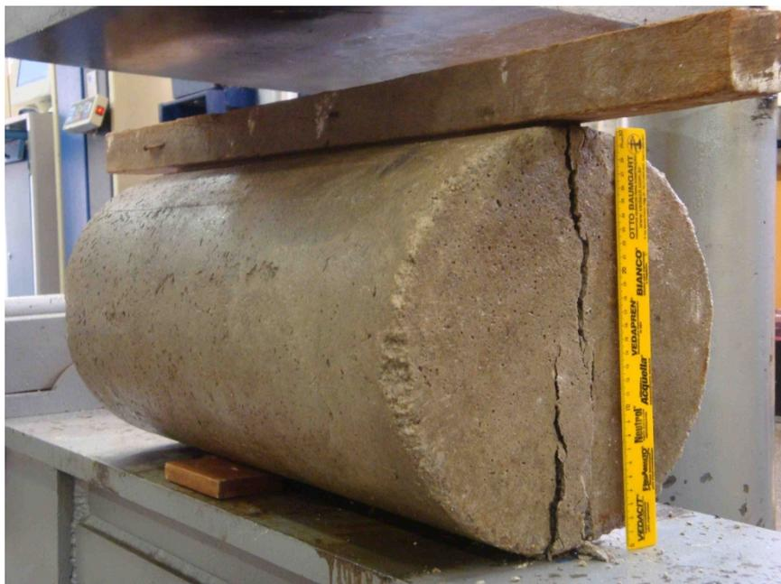
Figura 4. 15 – corpo de prova de 300 mm de diâmetro após ruptura por compressão diametral
