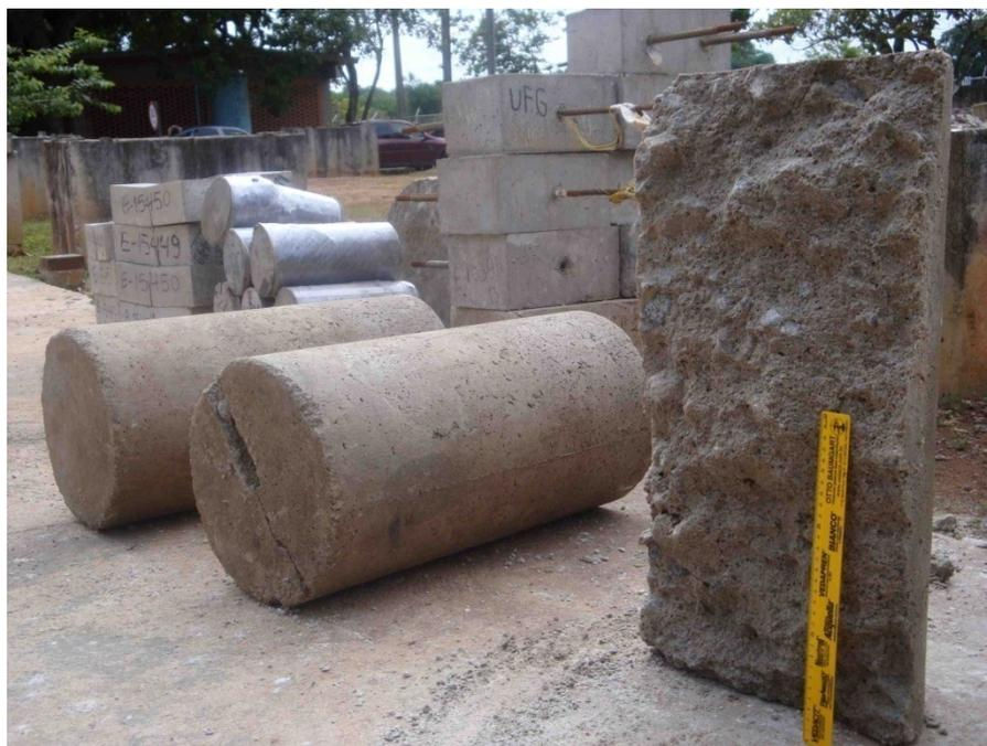
Figura 4. 16 – aspecto do interior do corpo de prova de 300 mm de diâmetro após ruptura por compressão diametral
