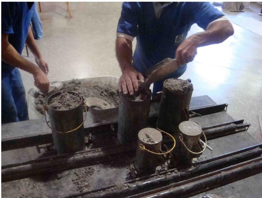
Figura 3. 4 – Lançamento do CCR em moldes de diferentes tamanhos
