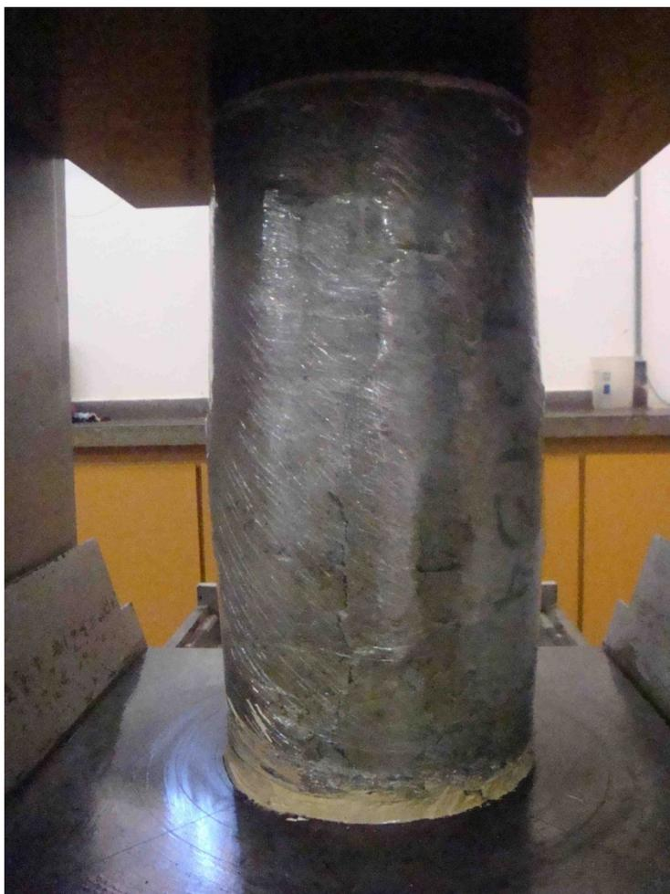
Figura 4. 11 – corpo de prova de 200 mm de diâmetro após ruptura por compressão uniaxial (simples)
