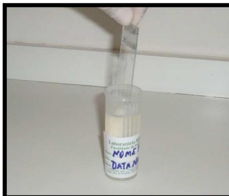
Figura 2- Técnica de fixação em álcool 95%
