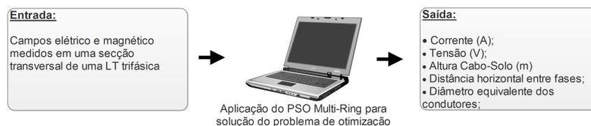
Figura 18 – Visão geral do método de estimação de parâmetros de LT por meio de otimização com PSO Multi-Ring.
