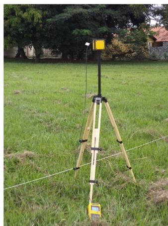
(b) Unidade básica com a sonda de campo elétrico acoplada sobre tripé
