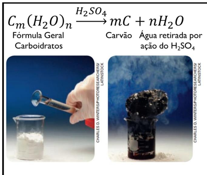
**Figura 4.** Esquema de carbonização de carboidratos via desidratação por ácido sulfúrico. (Fonte: Fotografia Charles D. Winters).
