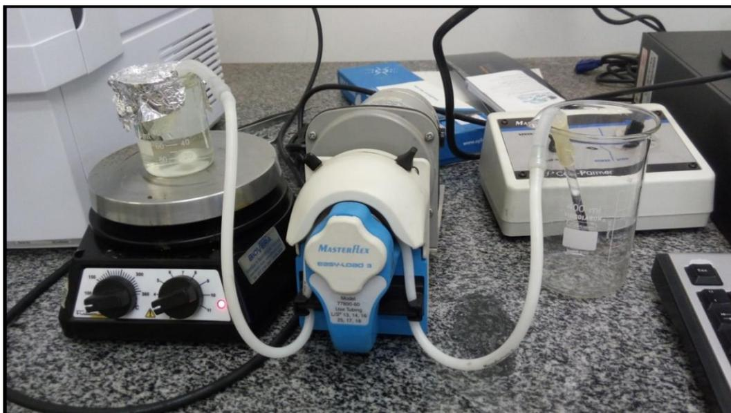
**Figura 9.** Montagem experimental do reator de leito fixo com fluxo descendente de reagentes.
