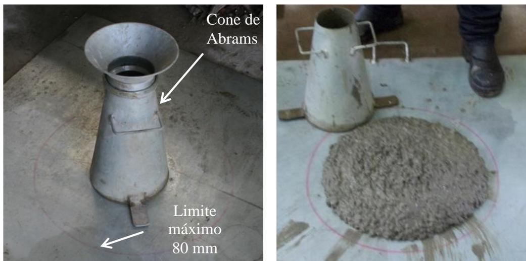
Figura 2.19- Ensaio *slump flow*
