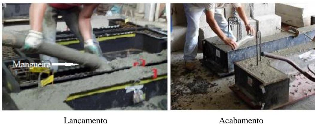
Figura 3.15- Lançamento e acabamento do concreto (CAA)
