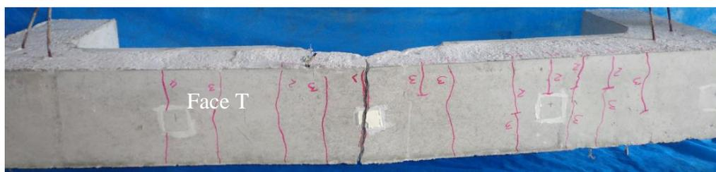
Figura 4.42- Região de ruptura pilar P100-38 ( $P_u = 441,0$  kN)
