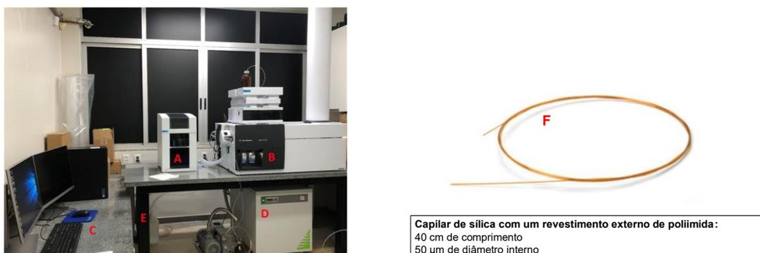
**Figura 9** - Sistema composto por um equipamento de eletroforese capilar desenvolvido pela Agilent Technologies modelo 7100 acoplado a um detector de espectrometria de massas modelo 6545 com fonte de ionização por eletrospray (ESI). **(A)** CE; **(B)** MS; **(C)** computadores; **(D)** gerador de nitrogênio; **(E)** cilindro de nitrogênio 5.0 e **(F)** capilar de sílica.
