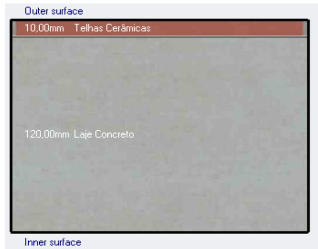
Figura 31 – Sistema cobertura original (C1).
