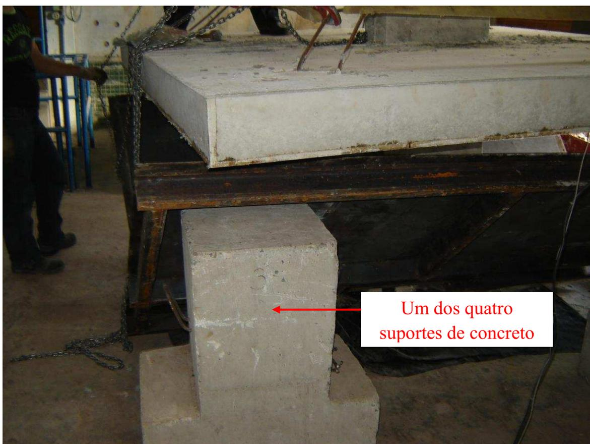
\*Os quatro suportes de concreto possibilitaram o que a forma fosse desparafusada com segurança.
