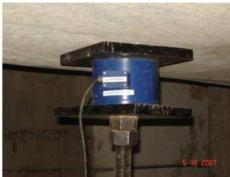
Figura 3.27 – Célula de carga
