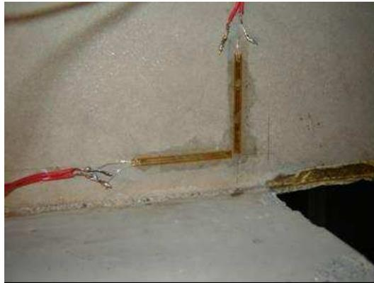
Figura 3.39 – Extensômetros do concreto colados
