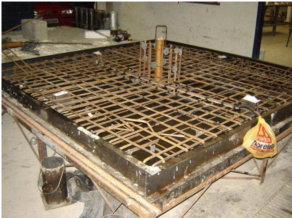
Figura 3.19 – Fotografia da laje L2 pronta para moldagem
