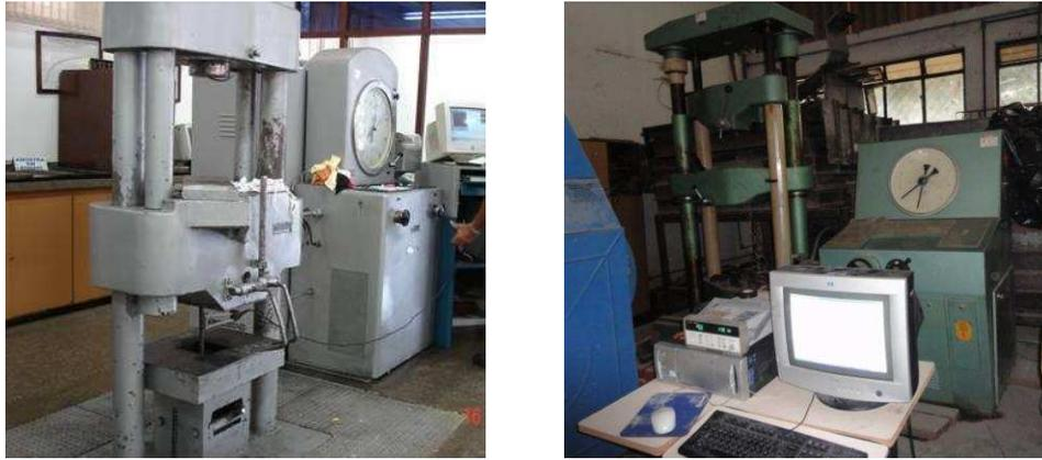
Figura 3.14 – Prensas utilizadas para o ensaio dos aços
