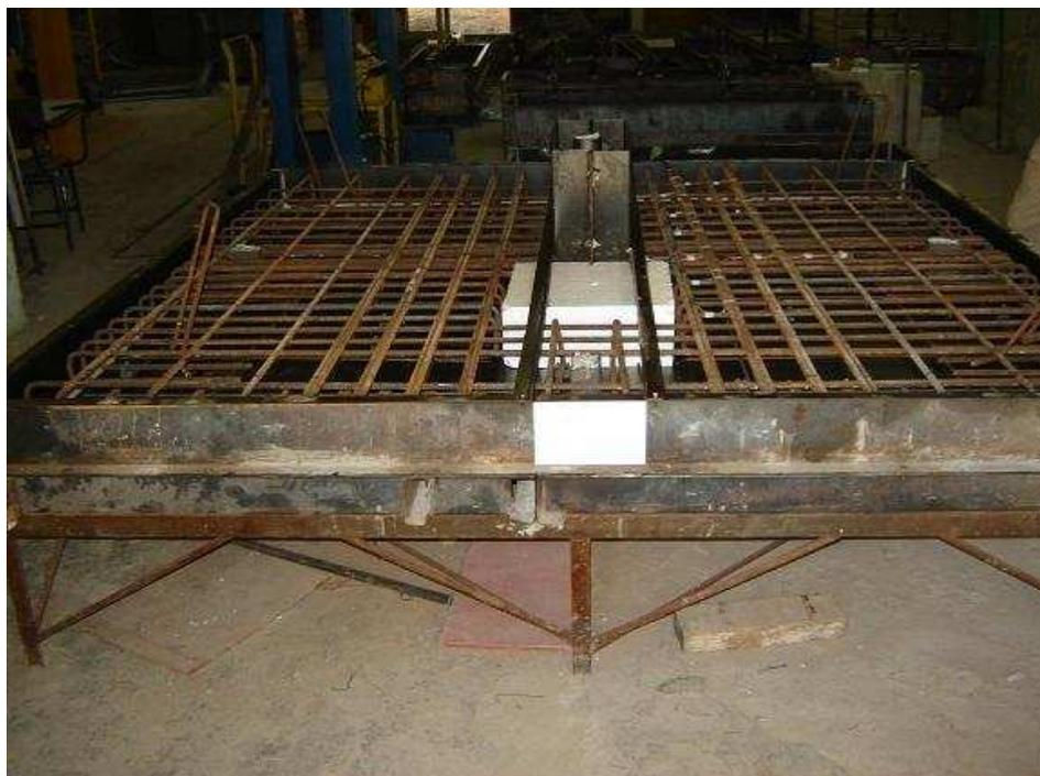
Figura 3.21 – Fotografia da laje L4 pronta para moldagem
