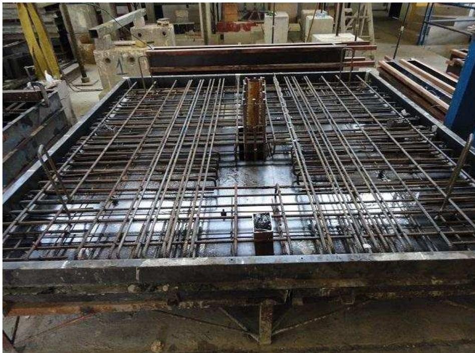
Figura 3.23 – Fotografia da laje L7 pronta para moldagem
