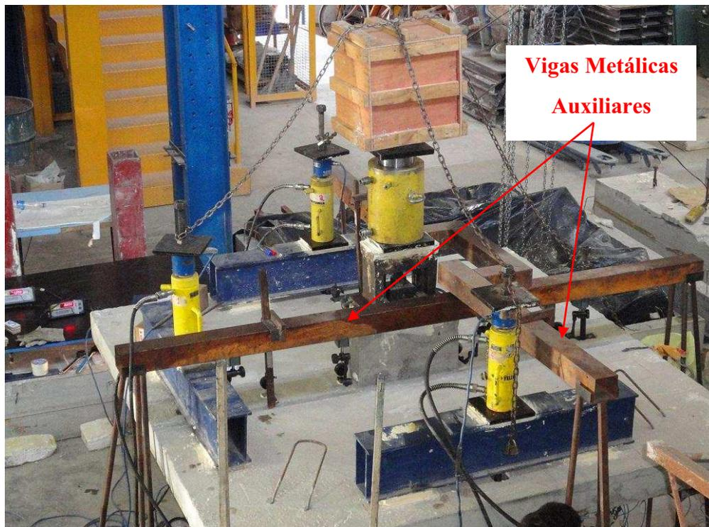
Figura 3.28 – Fotografia da estrutura para fixação dos defletômetros
