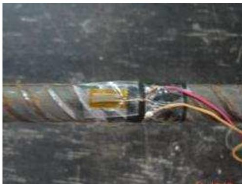
Figura 3.35 – Extensômetro colado
