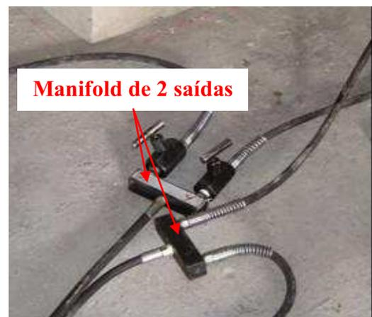
Figura 3.44 – Equipamento utilizado para aplicação de carga
