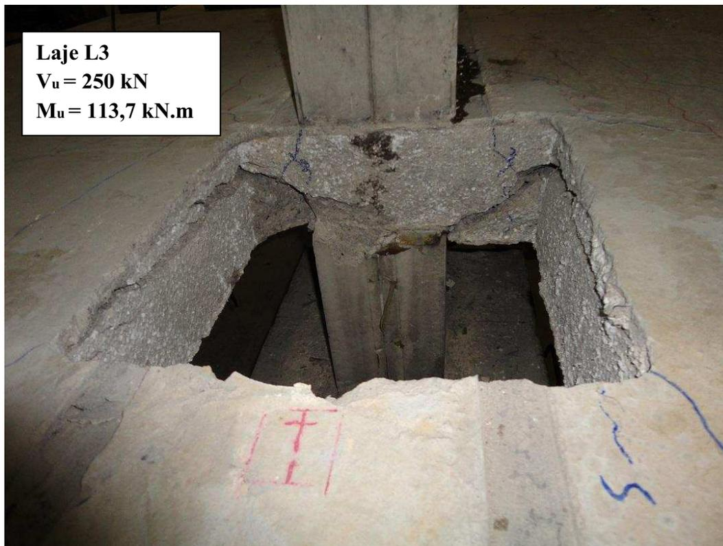
Figura 4.10 – Fotografia das superfícies de ruptura
