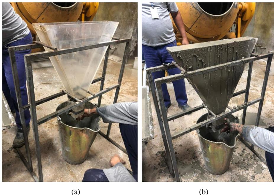
Figura 3.18 – Ensaio da Caixa L realizado, conforme norma brasileira (ABNT, 2017c): (a) antes da abertura da “comporta” e (b) após a abertura da “comporta”.
