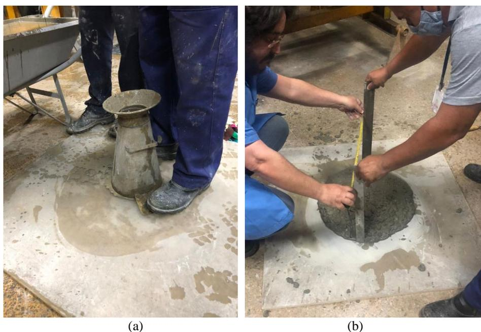
Figura 3.17 – Ensaio do Funil V realizado, conforme norma brasileira (ABNT, 2017b): (a) antes da colocação do concreto e (b) já com o concreto e antes de abrir o “fecho” inferior.
