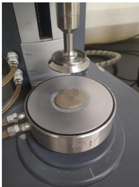
Figura 3 – Execução do ensaio de pasta no reômetro – deformação da amostra com 1mm de *gap*
