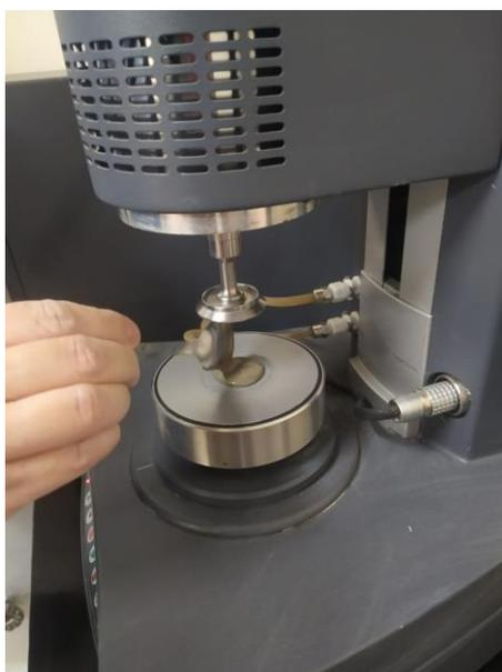
Figura 2 – Execução do ensaio de pasta no reômetro – ajustes do *gap*
