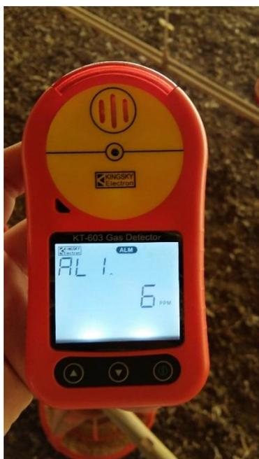
Imagem 3. Aparelho KT-603 utilizado para medição do nível de amônia. Fonte: Arquivo pessoal.
