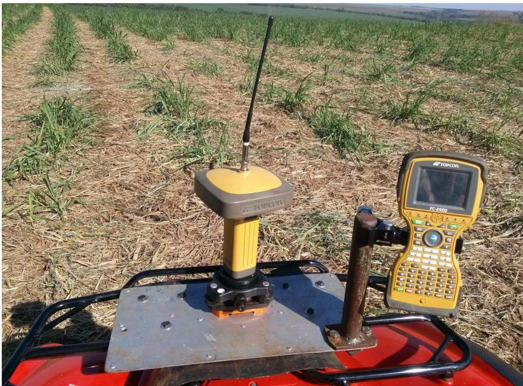
**Figura 3.** Suporte desenvolvido para acoplar o receptor GNSS ao quadriciclo.
