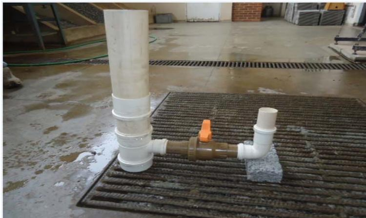
Figura 6.9 – Permeâmetro de carga variável.
