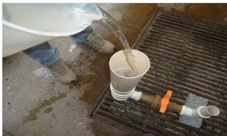
Figura 6.12 – Tubo acima do CP sendo preenchido com água.
