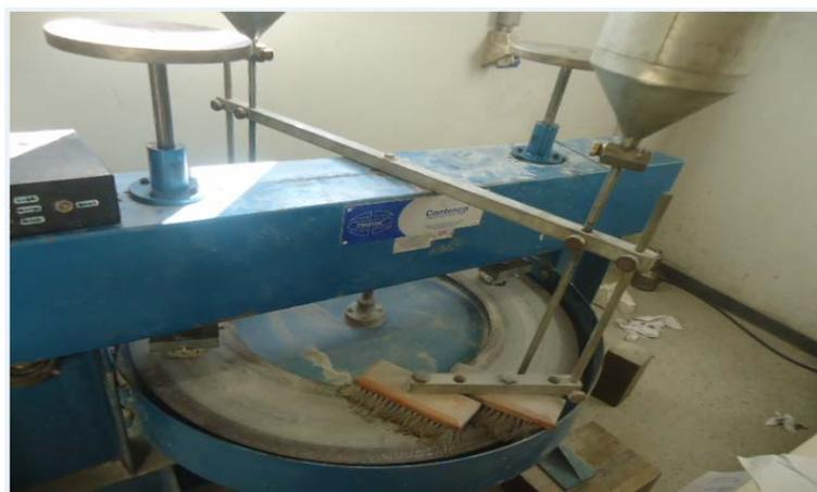
Figura 6.13 – Equipamento utilizado no ensaio de desgaste por abrasão.
