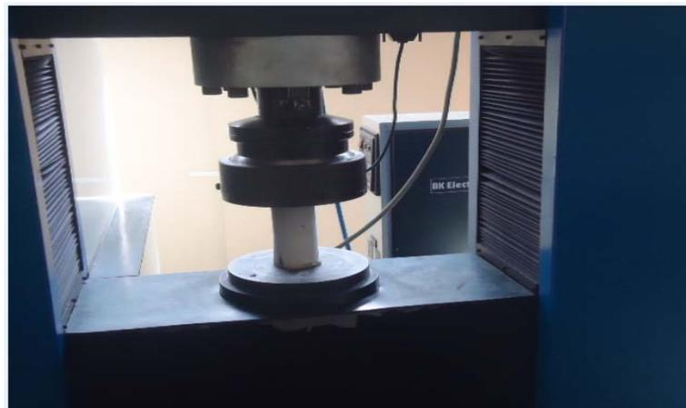
Figura 6.6 – Prensa, da marca EMIC, utilizada na medida da resistência à compressão do cimento.
