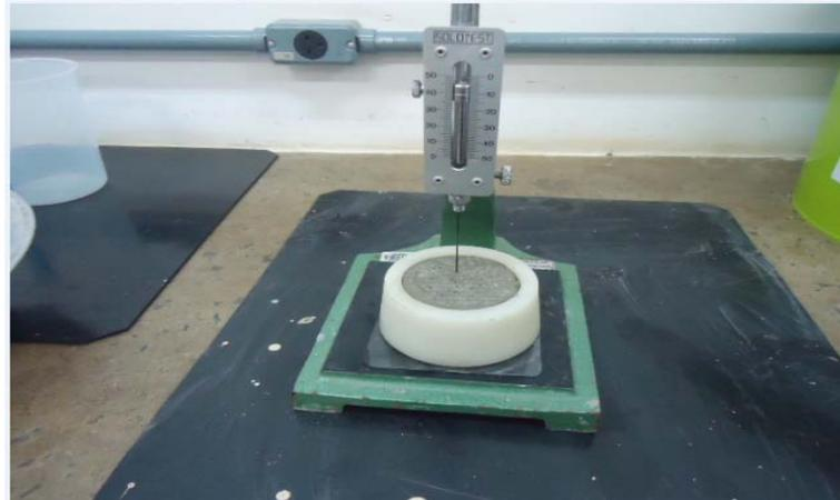
Figura 6.5 – Determinação dos tempos de pega por meio da agulha de Vicat.
