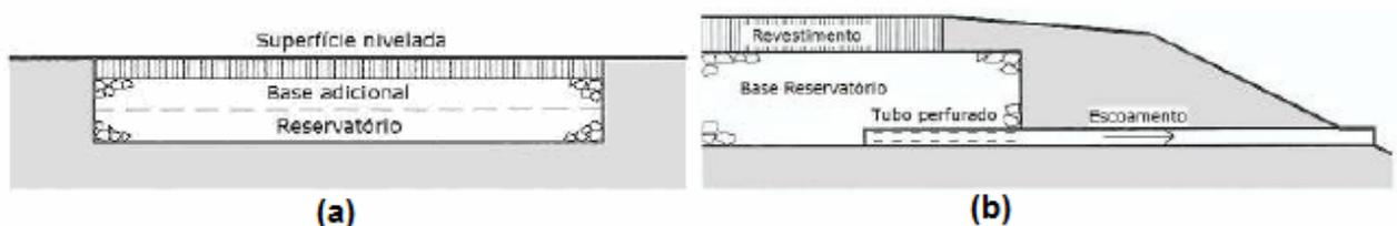
Figura 4.3 – Tipos de reservatórios. Reservatório nivelado (a). Reservatório com saída lateral utilizando tubos perfurados (b) (VIRGILIIS, 2009).
