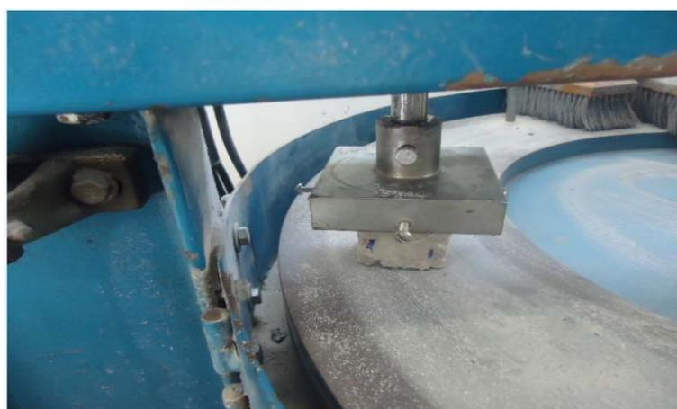
Figura 6.15 – Corpo de prova acoplado ao equipamento de ensaio de desgaste por abrasão.
