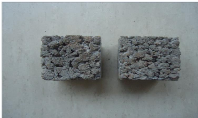
Figura 6.14 – Corpos de provas utilizados no ensaio de desgaste por abrasão.
