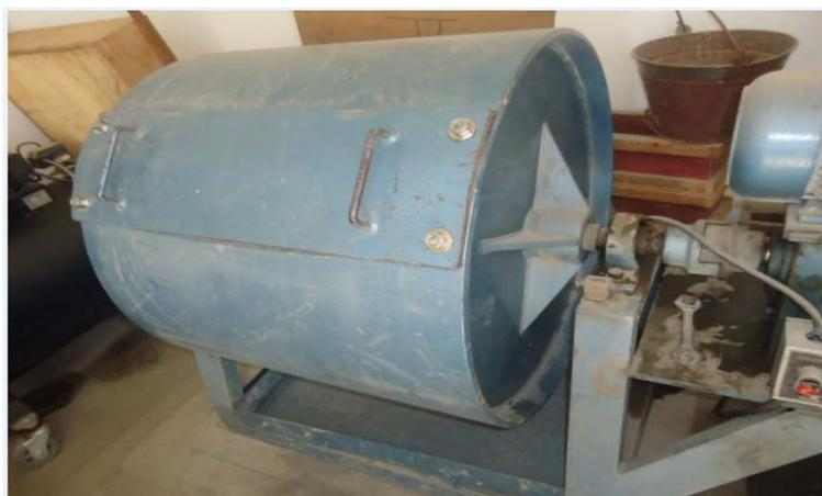
Figura 6.3 – Equipamento utilizado no ensaio de abrasão *Los Angeles*.
