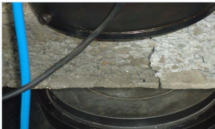
Figura 6.8 – Ensaio de resistência à compressão – corpo de prova rompido.
