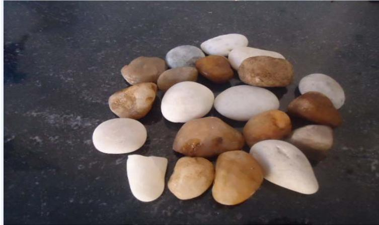
Figura 3.2 – Seixo rolado com superfície polida e pouco porosa.
