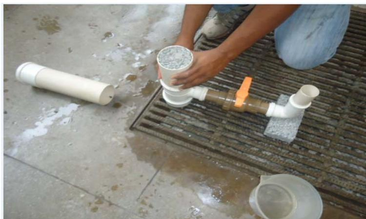
Figura 6.10 – Acoplagem da amostra no equipamento.
