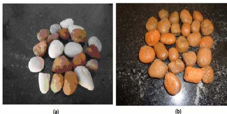
Figura 2.2 – Tipos de agregados quanto à origem. Agregado natural (seixo rolado) (a) e agregado artificial (argila expandida) (b).
