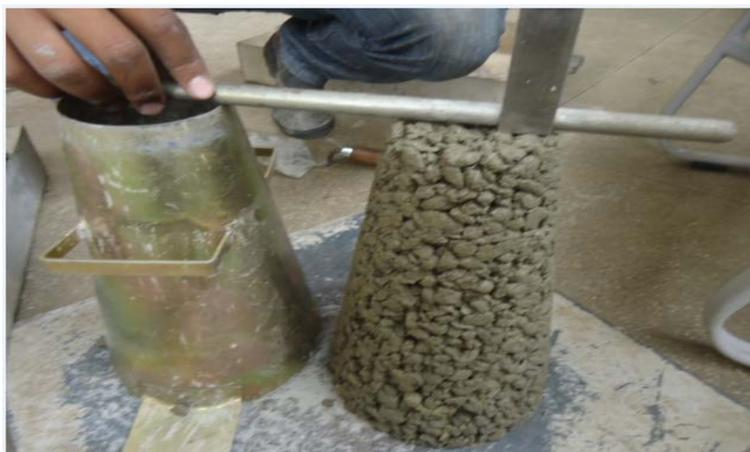
Figura 6.7 – Ensaio de abatimento de tronco de cone.
