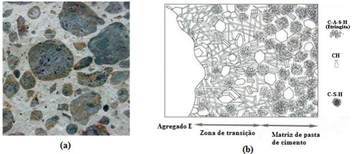
Figura 3.1 – Agregado espalhado em uma pasta de cimento (a). Microestrutura da pasta (b) (METHA e MONTEIRO, 2008).
