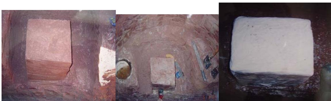
Figura 4.14 – Seqüência do processo para coleta de amostra indeformada.
