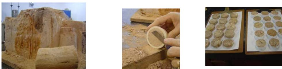
Figura 4.18 – A seqüência de fotos mostra os processos para a extração dos corpos de prova do ensaio de sucção do solo.
