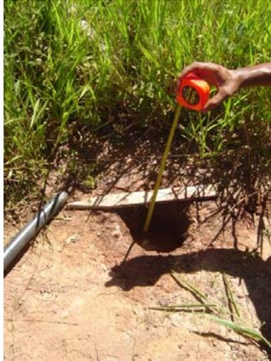
Figura 4.6 - Vista do poço piloto sendo monitorado.
