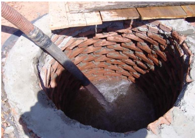
Figura 4.12 – Processo de abastecimento de todas as estruturas de infiltração nos ensaios de inundação e ensaios padronizados realizado em cada uma das etapas.
