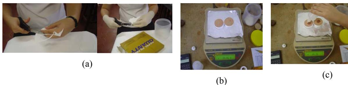
Figura 4.19 – a) Preparação dos papéis filtros comum e especial; b) pesagem do conjunto de corpo de prova com a umidade higroscópica; c) quantidade de água acrescida para variar a umidade do conjunto de dois corpos de prova.
