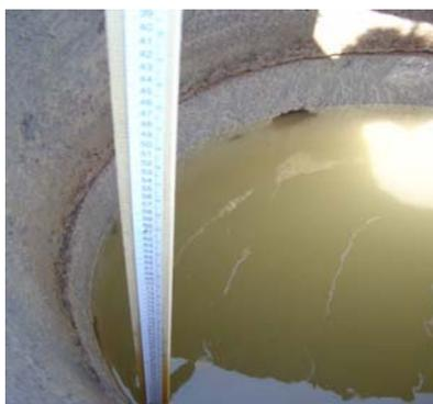
Figura 4.13 – Poço revestido em tubo de concreto armado com furos nas paredes sendo monitorado, processo usado para todas as estruturas.
