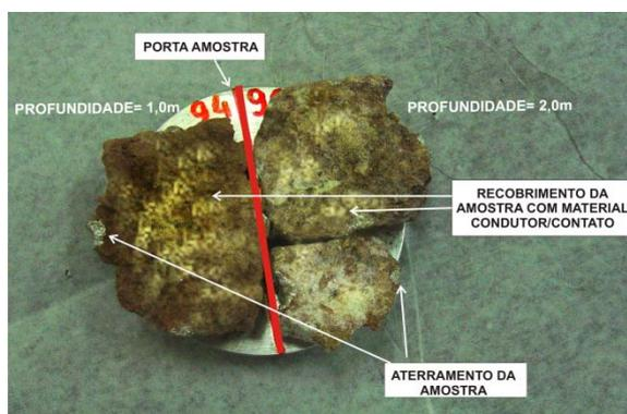
Figura 5.7 – Preparação da amostra para ser analisada no Microscópio Eletrônico de Varredura. Metalização com ouro e aterramento com prata.
